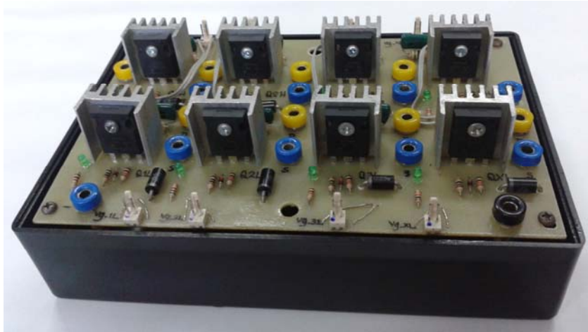
ภาพที่ 3.19 แผงวงจรอินเวอร์เตอร์ 3 เฟสแบบเต็มคลื่นที่ประกอบเสร็จแล้ว (ต่อประกอบวงจรโดยผู้ใช้)
