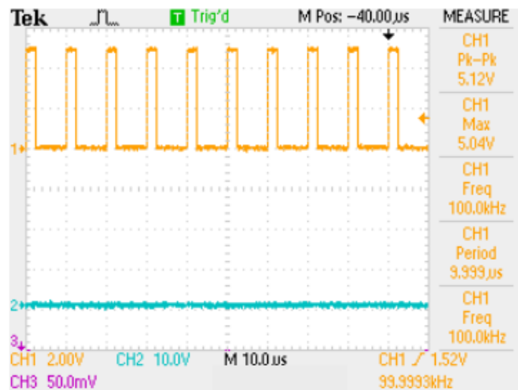
ภาพที่ 4.3 รูปคลื่นสัญญาณขาออกที่ขา PWM1L (ขา 18 จากไอซี 74AC244) (โดยมีขนาดสัญญาณที่ 5 V.)
