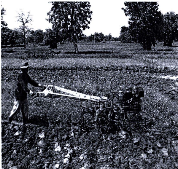
ภาพที่ 4.3 การไถเตรียมดินโดยการใช้น้ำมันเชื้อเพลิงสบูดำ (B100)
