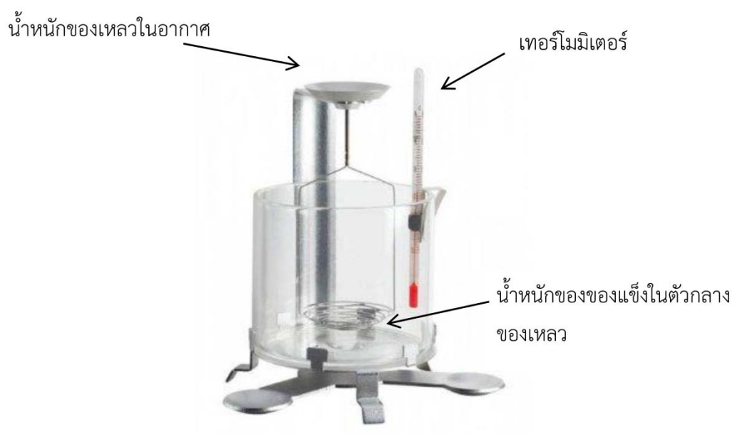
รูป 14 ชุดหาความหนาแน่น (Density Kit) ที่สามารถต่อเข้ากับเครื่องชั่งวิเคราะห์ 4 ตำแหน่ง
