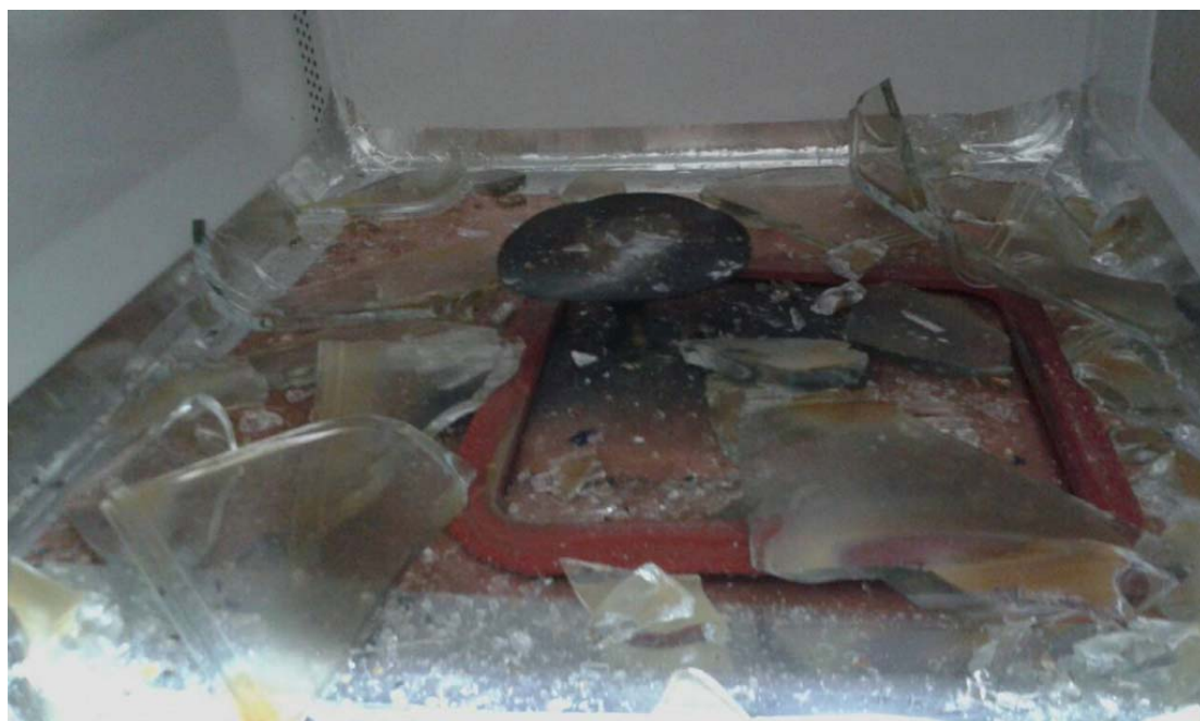
รูปที่ 6 แสดงภาพการแตกของห้องสุญญากาศ เมื่อทำการจ่ายแรงดันไฟฟ้ากระแสตรง -300 V ให้กับฐานวางชิ้นงาน (ฐานวางชิ้นงานที่ทำจากวัสดุทองแดงเกิดการบิดเบี้ยวเนื่องจากถูกแรงกระแทกอย่างแรง)
