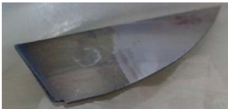
รูปที่ 12 แสดงซิลิกอนที่ผ่านการปลูกฟิล์มคาร์บอนโดย C_2H_2 plasma ซึ่งบริเวณด้านซ้าย (สีน้ำตาล) แสดงบริเวณที่มีชั้นของคาร์บอนเคลือบอยู่ และบริเวณด้านขวา (สีเทา) แสดงบริเวณที่ผิวของซิลิกอนไม่สัมผัสกับพลาสมาเนื่องจากการเคลือบฟิล์มบางของพอลิเมอร์ที่สามารถลอกออกได้เคลือบทับอยู่ระหว่างการปลูกฟิล์มและภาพที่แสดงนี้ได้ลอกฟิล์มบางพอลิเมอร์ออกแล้ว
