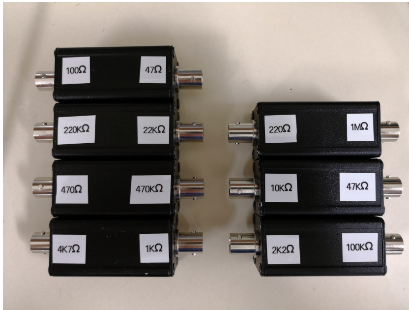
รูปที่ 2.4 กล่องตัวต้านทานที่ใส่ BNC connector ทำให้สะดวกสบายในการเปลี่ยนค่า ทำให้เครื่องไม่ต้องผ่านการบำรุงรักษาเยอะเกินไป
