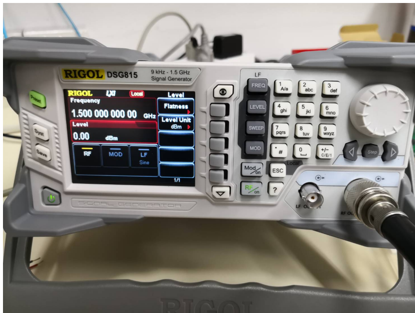
รูปที่ 1.4 แหล่งกำเนิดสัญญาณที่ 1.5 GHz ที่เราใช้เป็นสัญญาณอ้างอิงสำหรับ DDS ทุก channel
