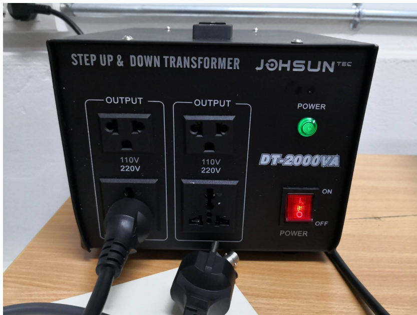
รูปที่ 1.8 หม้อแปลงที่ซื้อมาจาก aliexpress ตามความตั้งใจเดิมเราซื้อหม้อแปลงตัวนี้มาเพื่อนำมาใช้กับอุปกรณ์ที่นำมาจากประเทศสหรัฐอเมริกา ซึ่งใช้แรงดันไฟฟ้า 120 V แต่โชคดีที่หม้อแปลงตัวนี้มี option ที่ให้แรงดันไฟฟ้า 220 V ด้วย ซึ่งทำให้หน้าตัด ground loop จากวงจรของเราจากไฟบ้าน (ไฟในห้องทดลอง) ทำให้สัญญาณรบกวนที่มาจาก line power นั้นหายไป
