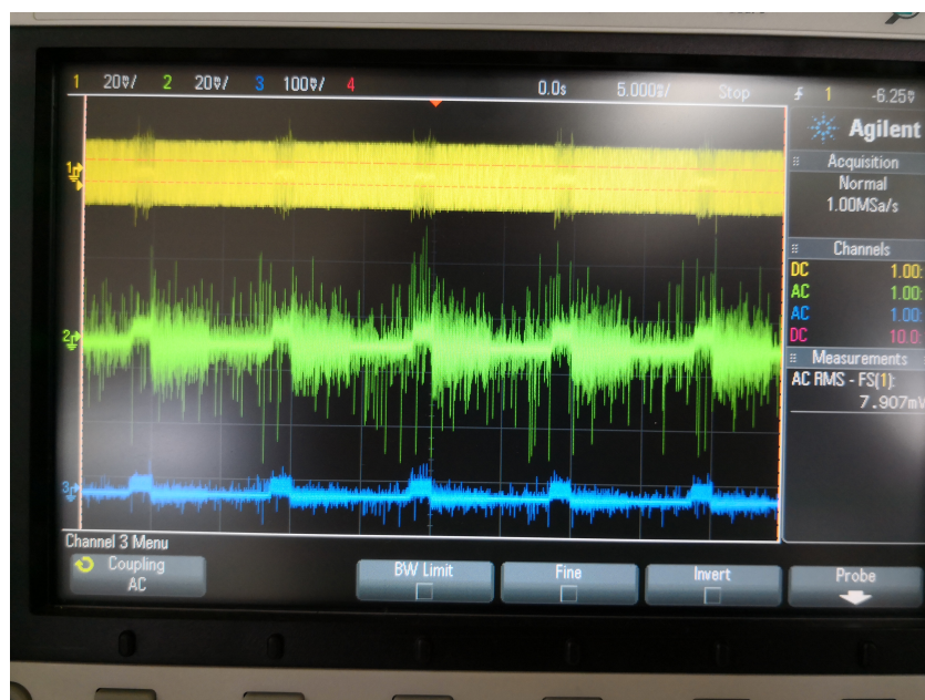
รูปที่ 1.7 สัญญาณรบกวนของความถี่ที่วัดได้บน oscilloscope จะสังเกตว่าสัญญาณรบกวนนั้นมี noise อยู่ที่ 50 Hz ซึ่งเป็นความถี่ของไฟในห้องทดลอง ทำให้เรามีสมมุติฐานว่า น่าจะเกิดจาก ground loop ในห้องทดลอง
