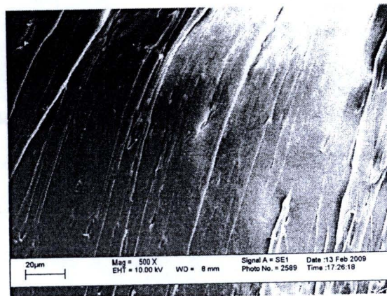
รูปที่ 3.8 พลาสติกพอลิเอทิลีนรีไซเคิลที่ผ่านการดิ่งหมัก (X 500)
