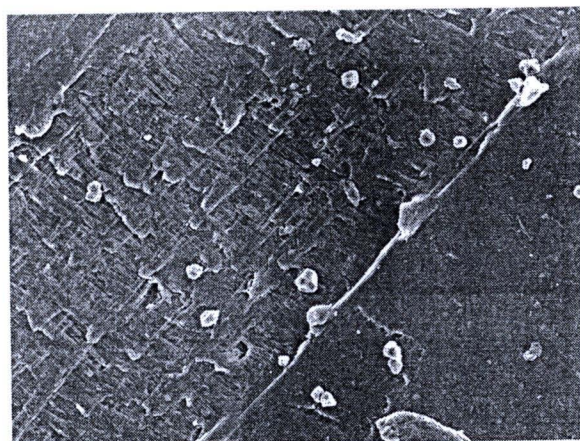
รูปที่ 3.13 พลาสติกพอลิเอทิลีนรีไซเคิลที่ผ่านการดัดหมึก ผสมแป้งข้าวเจ้า 3% และกรดซิตริก 1.5% โดยน้ำหนัก
