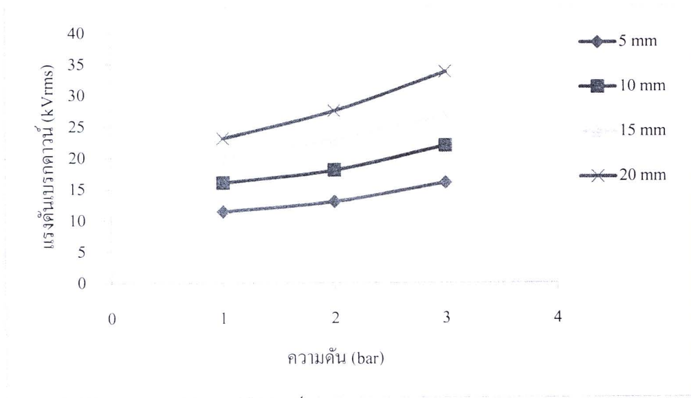
รูปที่ 4.6 ค่าความคงทนต่อแรงดันไฟฟ้าของก๊าซ O 2 อิเล็กโตรดแบบปลายแหลม-ระนาบ
