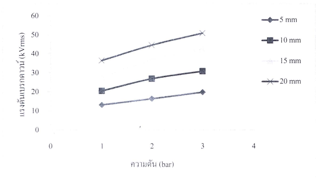
รูปที่ 4.8 แสดงค่าความคงทนต่อแรงดันไฟฟ้าของ Air อิเล็กโตรดแบบปลายแหลม-ระนาบ
