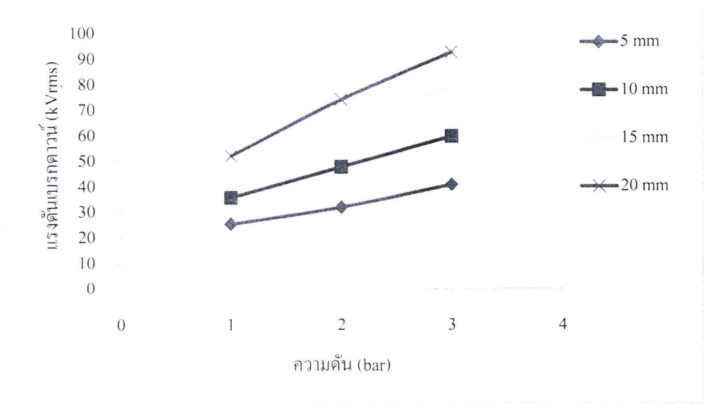
รูปที่ 4.14 ค่าความทนต่อแรงดันไฟฟ้าของก๊าซ N 2 อิเล็กโตรดแบบทรงกลม-ระนาบ
