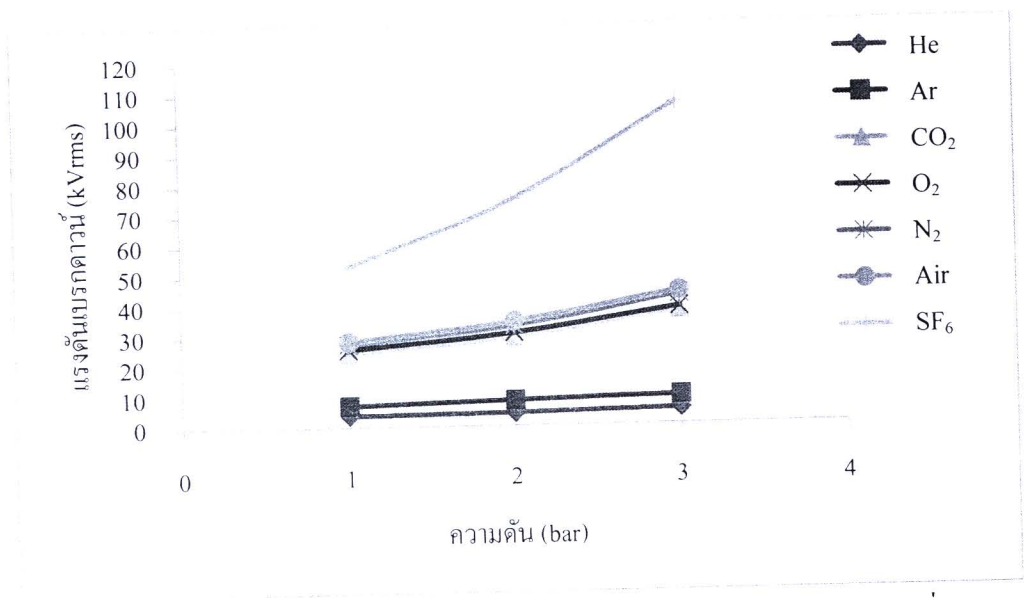
รูปที่ 4.32 ค่าความคงทนต่อแรงดันไฟฟ้าของก๊าซ He, Ar, CO 2 , O 2 , N 2 , Air และ SF 6 ที่ระยะแกป 5 มิลลิเมตร อิเล็กโตรดแบบระนาบ-ระนาบ
