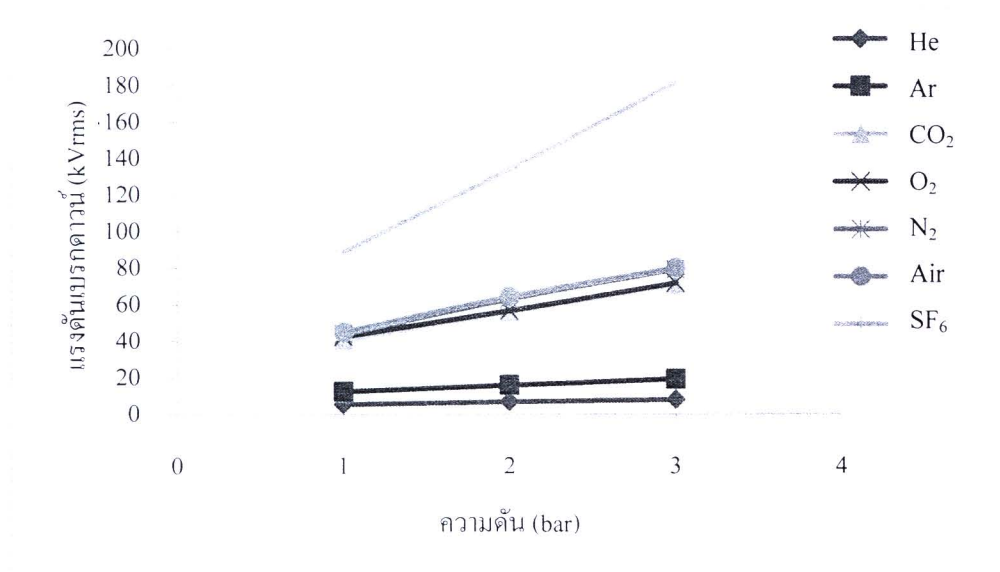
รูปที่ 4.30 ค่าความคงทนต่อแรงดันไฟฟ้าของก๊าซ He, Ar, CO 2 , O 2 , N 2 , Air และ SF 6 ที่ระยะแกป 15 มิลลิเมตร อิเล็กโตรดแบบทรงกลม-ระนาบ
