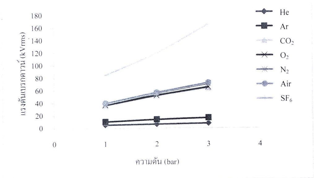
รูปที่ 4.33 ค่าความคงทนต่อแรงดันไฟฟ้าของก๊าซ He, Ar, CO 2 , O 2 , N 2 , Air และ SF 6 ที่ระยะแก๊ป 10 มิลลิเมตร อิเล็กโตรดแบบระนาบ-ระนาบ
