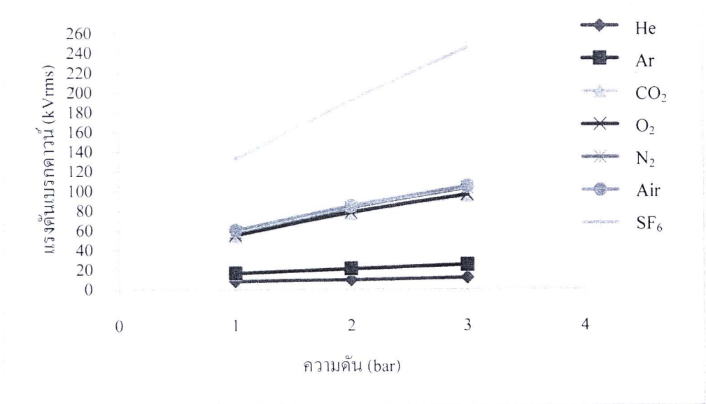
รูปที่ 4.35 ค่าความคงทนต่อแรงดันไฟฟ้าของก๊าซ He, Ar, CO 2 , O 2 , N 2 , Air และ SF 6 ที่ระยะแก๊ป 20 มิลลิเมตร อิเล็กโตรดแบบระนาบ-ระนาบ
