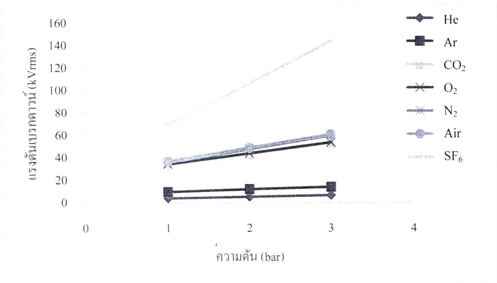
รูปที่ 4.29 ค่าความคงทนต่อแรงดันไฟฟ้าของก๊าซ He, Ar, CO 2 , O 2 , N 2 , Air และ SF 6 ที่ระยะแก๊ป 10 มิลลิเมตร อิเล็กทรอนิกส์แบบทรงกลม-ระนาบ
