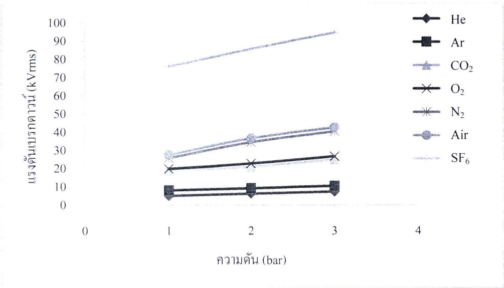
รูปที่ 4.26 ค่าความคงทนต่อแรงดันไฟฟ้าของก๊าซ He, Ar, CO 2 , O 2 , N 2 , Air และ SF 6 ที่ระยะแก๊ป 15 มิลลิเมตร อิเล็กโตรดแบบปลายแหลม-ระนาบ
