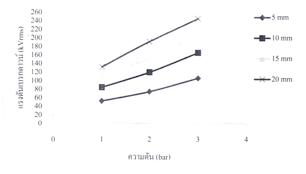
รูปที่ 4.23 ค่าความทนต่อแรงดันไฟฟ้าของก๊าซ SF 6 อิเล็กโตรดแบบระนาบ-ระนาบ
