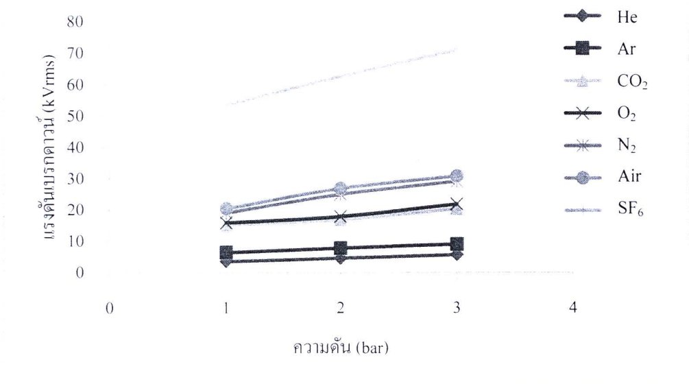
รูปที่ 4.25 ค่าความคงทนต่อแรงดันไฟฟ้าของก๊าซ He, Ar, CO 2 , O 2 , N 2 , Air และ SF 6 ที่ระยะแก๊ป 10 มิลลิเมตร อิเล็กโตรดแบบปลายแหลม-ระนาบ
