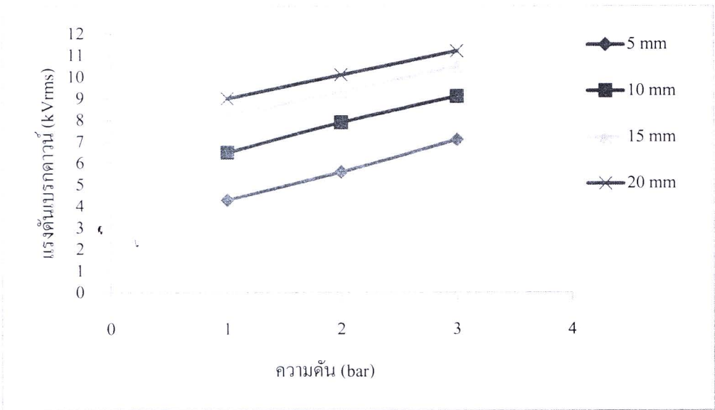
รูปที่ 4.4 ค่าความคงทนต่อแรงดันไฟฟ้าของก๊าซ Ar อิเล็กโตรดแบบปลายแหลม-ระนาบ
