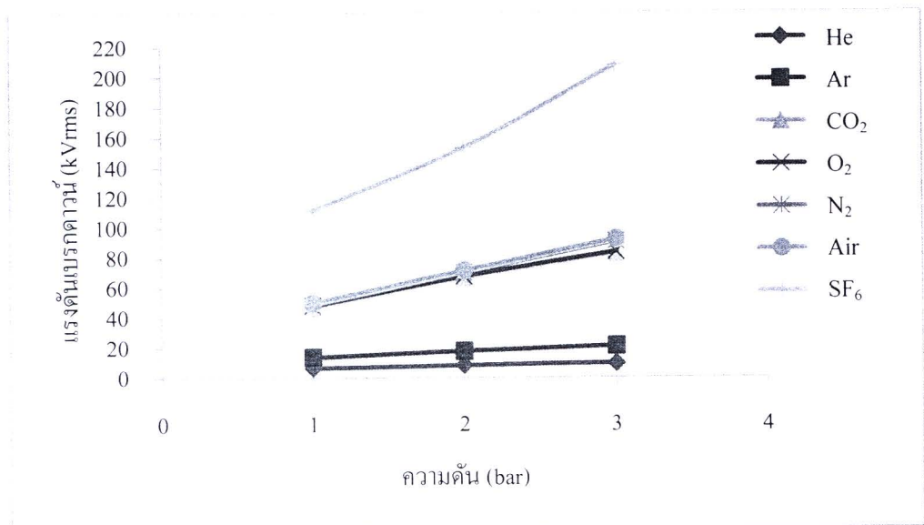
รูปที่ 4.34 ค่าความคงทนต่อแรงดันไฟฟ้าของก๊าซ He, Ar, CO 2 , O 2 , N 2 , Air และ SF 6 ที่ระยะแก๊ป 15 มิลลิเมตร อิเล็กโตรดแบบระนาบ-ระนาบ
