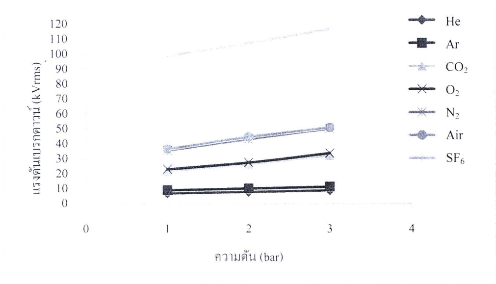
รูปที่ 4.27 ค่าความคงทนต่อแรงดันไฟฟ้าของก๊าซ He, Ar, CO 2 , O 2 , N 2 , Air และ SF 6 ที่ระยะแก๊ป 20 มิลลิเมตร อิเล็กโตรดแบบปลายแหลม-ระนาบ
