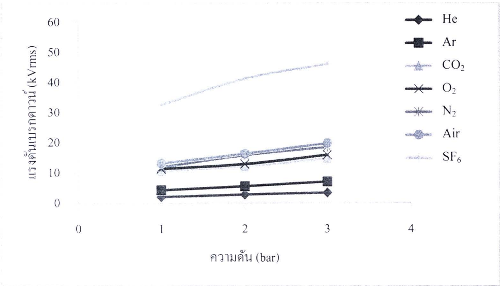
รูปที่ 4.24 ค่าความคงทนต่อแรงดันไฟฟ้าของก๊าซ He, Ar, CO 2 , O 2 , N 2 , Air และ SF 6 ที่ระยะแก๊ป 5 มิลลิเมตร อิเล็กโตรดแบบปลายแหลม-ระนาบ
