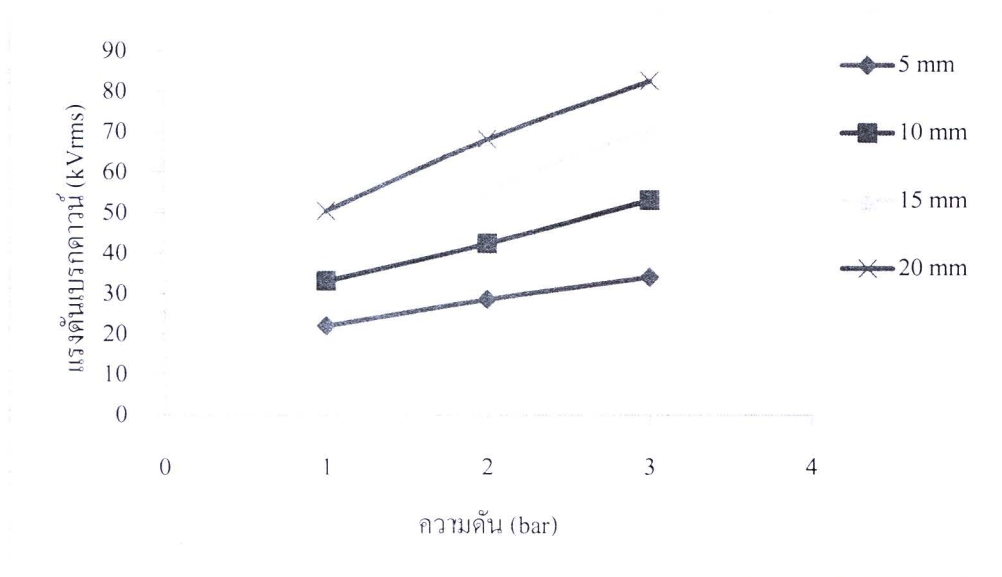
รูปที่ 4.12 ค่าความคงทนต่อแรงดันไฟฟ้าของก๊าซ CO 2 อิเล็กโตรดแบบทรงกลม-ระนาบ
