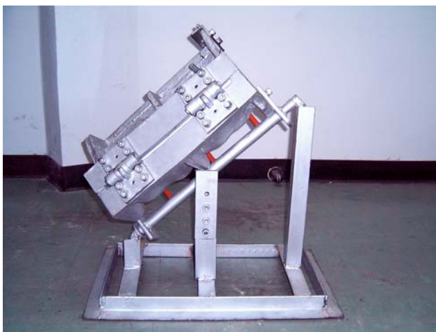
ภาพที่ 58 แม่พิมพ์ที่ใช้ในกระบวนการผลิตแบบ RIM (ด้านหลัง)
