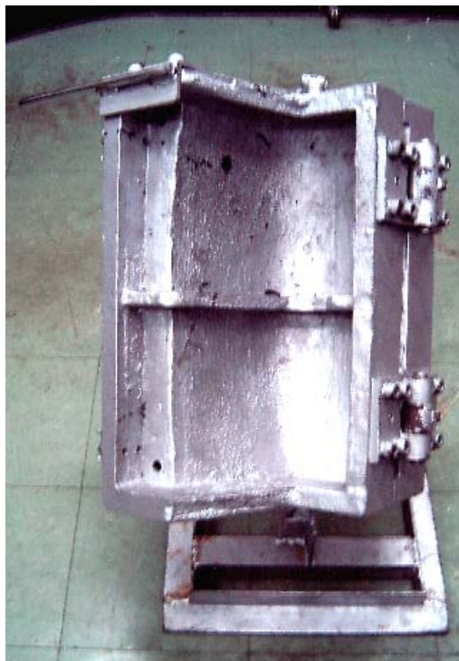
ภาพที่ 59 แม่พิมพ์ที่ใช้ในกระบวนการผลิตแบบ RIM (ด้านนอก)
