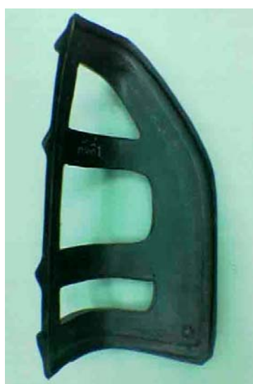
ภาพที่ 148 ด้านหน้า (ภาพ ก) และด้านหลัง (ภาพ ข) ของฝาครอบประดับกรอบไฟท้ายวัสดุเป็น โพลียูรีเทนแบบแข็ง
