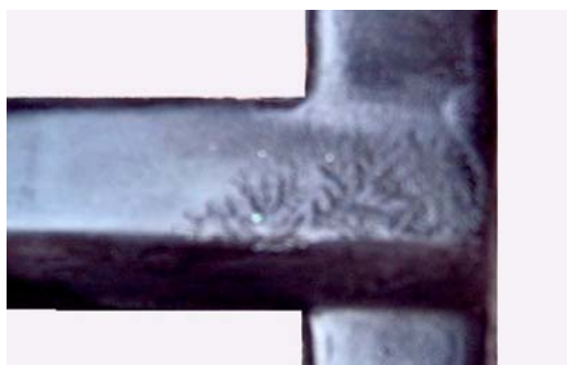
ภาพที่ 150 สภาพรอยย่นของผิวชิ้นงานที่ไม่ได้คุณภาพ
