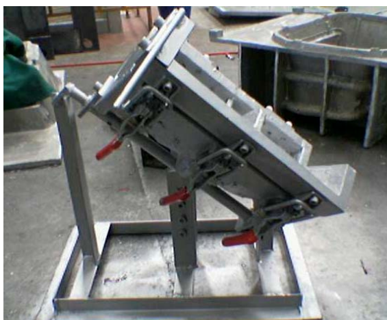
ภาพที่ 146 แม่พิมพ์อลูมิเนียม ที่นำไปใช้ในการผลิตในงานวิจัยนี้
