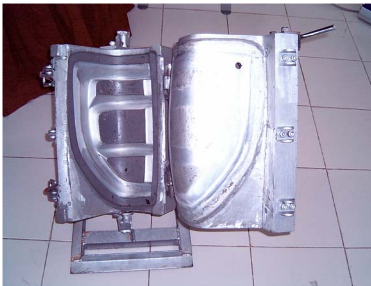
ภาพที่ 60 แม่พิมพ์ที่ใช้ในกระบวนการผลิตแบบ RIM (ด้านใน)
