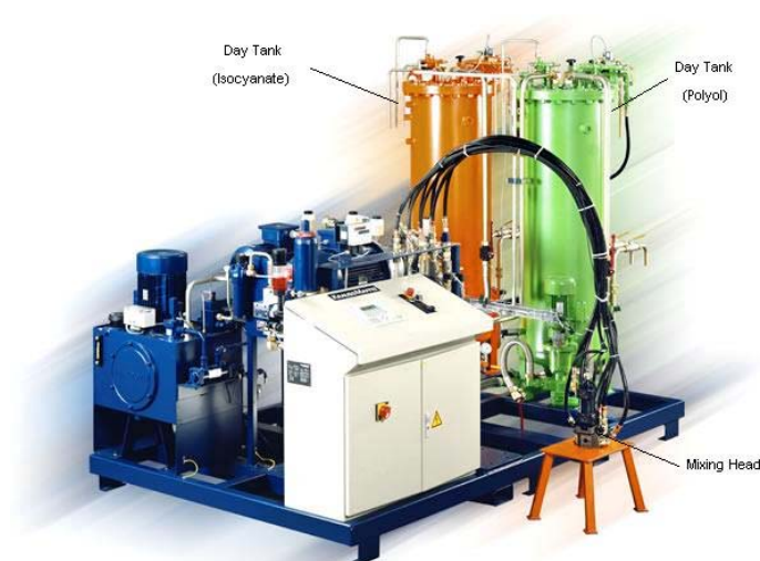
ภาพที่ 2 เครื่อง RIM รุ่น RIM-STAR ECO II (บริษัท Krauss Maffei จำกัด, 2004)
