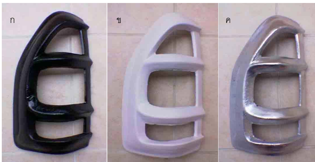
ภาพที่ 151 ชิ้นงานที่ผลิตจากกระบวนการ RIM ภายหลังตบแต่งเรียบร้อยแล้วเป็นสีต่าง ๆ (ก. สีดำ ข. สีขาว และ ค. สีเงิน)
