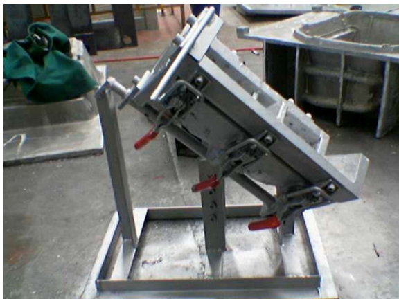
ภาพที่ 18 แม่พิมพ์อลูมิเนียมที่ใช้ในการผลิตแบบ RIM
