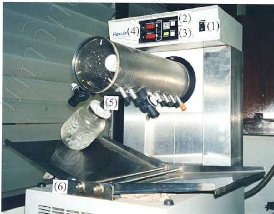
รูป 2.2 (ข) การระเหิดน้ำออกจากสารละลายโปรตีนในระบบที่เป็นสุญญากาศของเครื่อง Lyophilizer ซึ่งมีสวิตช์ปิด-เปิดเครื่อง (1) ปุ่มให้เครื่องทำงาน (2) ปุ่มช่วยละลายน้ำแข็ง (3) จอแสดงอุณหภูมิและความดันของเครื่อง (4) ท่อสำหรับต่อเข้ากับขวดสารตัวอย่าง (5) และถาดสำหรับรองน้ำที่เกาะข้างขวดสารตัวอย่าง (6)
