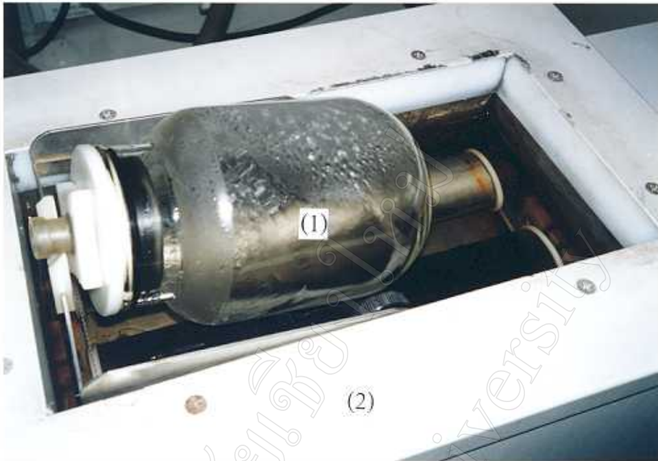
รูป 2.2 (ก) การทำสารละลายโปรตีนให้แข็งตัวในขวด (1) ซึ่งหมุนอยู่ในสารละลายเอทานอลที่เย็นจัดในเครื่อง Freezer (2)
