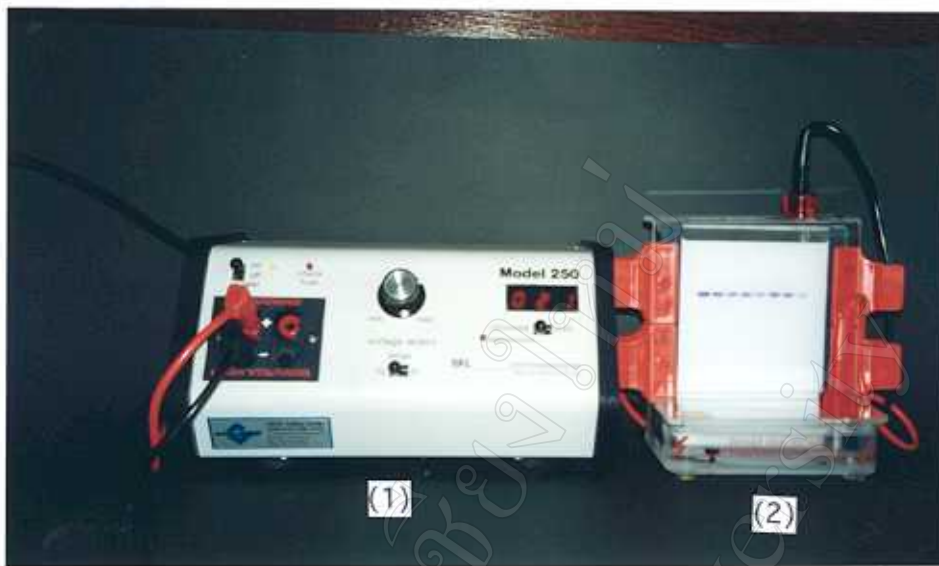
รูป 2.5 การแยกโปรตีนโดย SDS-PAGE ซึ่งประกอบด้วย Power supply (1) และ ชุดอิเล็กโตรฟอรีซิส (2)
