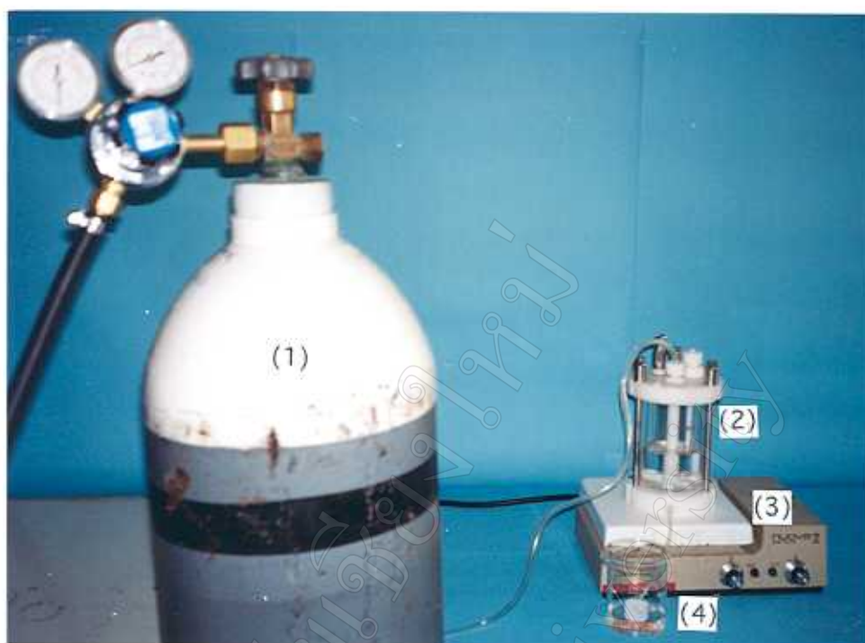
รูป 2.8 การทำอัลตราฟิลเตรชันของสารละลายโปรตีนบริสุทธิ์โดยผ่านเมมเบรนในโตรเจน (1) เข้าสู่อัลตราฟิลเตรชันยูนิต (2) ซึ่งมีสารละลายโปรตีนบริสุทธิ์ที่ถูกกวนตลอดเวลา ด้วยแท่งกวนแม่เหล็ก (3) และเก็บสารละลายที่ผ่านเมมเบรนไว้ในบีกเกอร์ (4)
