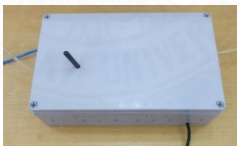
ภาพที่ 3.2 เครื่องตรวจวัดกลิ่นโดยใช้เทคโนโลยีจมูกอิเล็กทรอนิกส์
