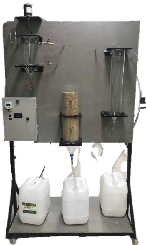
รูปที่ 4 แบบจำลองระบบผลิตน้ำประปาจากน้ำผิวดินและระบบบำบัดน้ำเสียแบบตะกอนเร่ง เพื่อการเรียนการสอนวิศวกรรมสิ่งแวดล้อม
