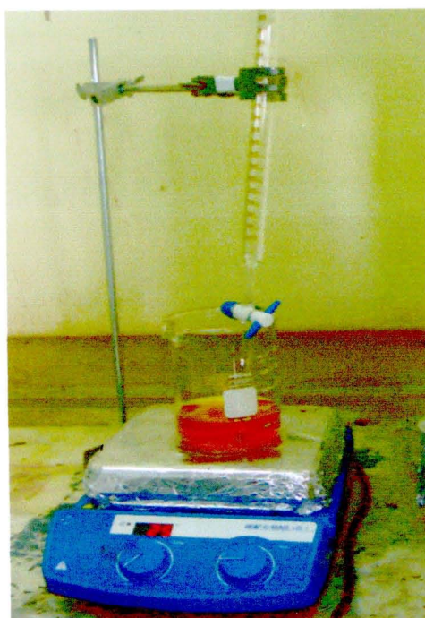
รูปที่ 3.5 การผสมสารละลาย \text{Sr}(\text{NO}_3)_2 และ \text{Fe}(\text{NO}_3)_3 \cdot 9\text{H}_2\text{O}
