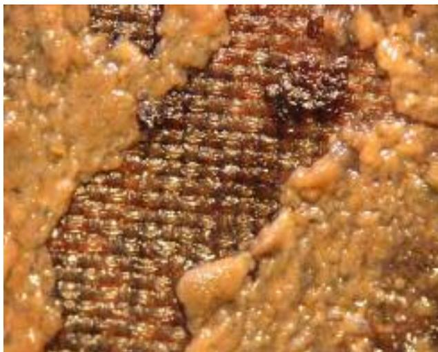
รูปที่ 4.9 เมือกชีวภาพที่เกิดขึ้นในระบบแผ่นหมุนชีวภาพ
