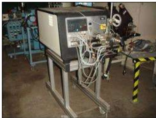
รูปที่ 3.3 เครื่องหลอมผสมภายในรุ่น Haake Rheomix
