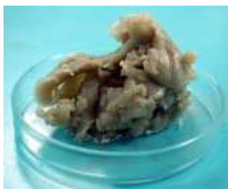
รูปที่ 3.4 ตัวอย่างพอลิเมอร์ผสมที่ได้จากเครื่องหลอมผสมภายใน
