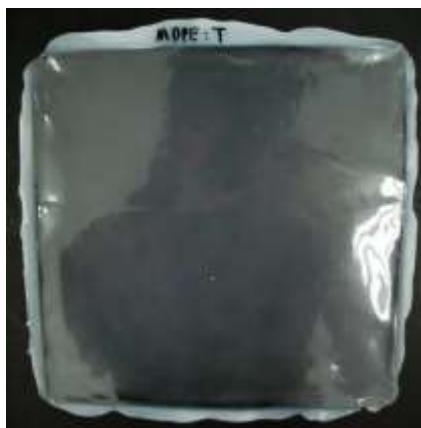
รูปที่ 3.9 ตัวอย่างแผ่นฟิล์มที่ขึ้นรูปออกมาด้วยเครื่องอัดขึ้นรูปด้วยความร้อน
