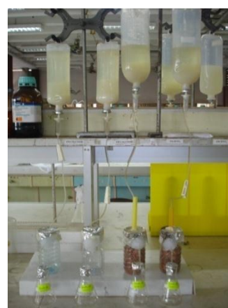
รูปที่ 2.4 แสดงระบบการหมักแบบต่อเนื่องของตัวกลางอิฐมอญเผาเนื้อพรุน
