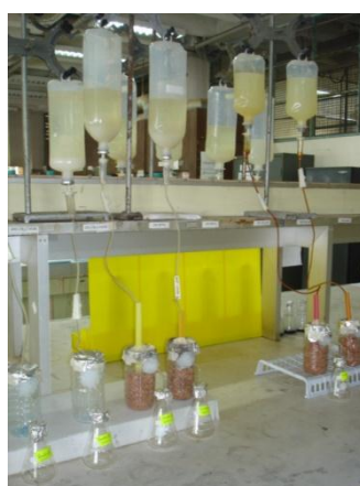
รูปที่ 2.4 แสดงระบบการหมักแบบต่อเนื่องของตัวกลางอิฐมอญเผาเนื้อพรุน
