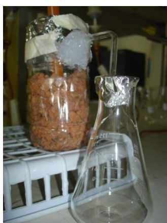
รูปที่ 2.4 แสดงระบบการหมักแบบต่อเนื่องของตัวกลางอิฐมอญเผาเนื้อพรุน
