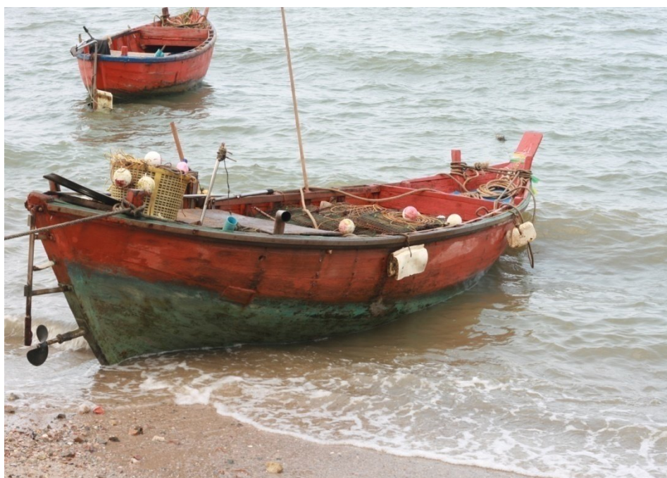
ภาพผนวกที่ 4 ลักษณะของเรือที่ใช้ในการทำประมงปูม้าพื้นบ้าน ซึ่งเรือที่ใช้มีขนาด 8-11 แรงม้า มีความกว้างประมาณ 1.7-2 เมตร และความยาวเรือประมาณ 5 เมตร
