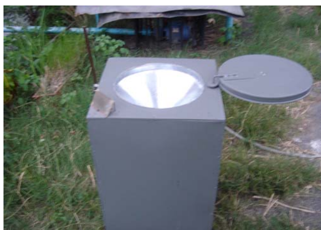
ภาพที่ 2 เครื่องมือเก็บตัวอย่างน้ำฝน
