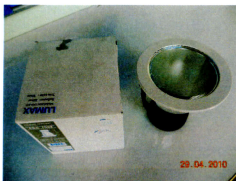
รูปที่ 4.12 โคมไฟที่ปิดด้วยกระจกขาวุ่น
