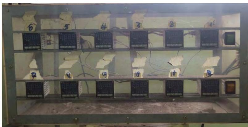
รูปที่ 3.8 อุปกรณ์วัดอุณหภูมิ
