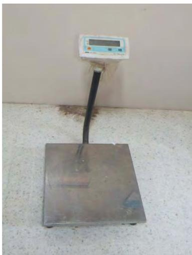
รูปที่ 3.9 เครื่องชั่งน้ำหนักดิจิทัล
