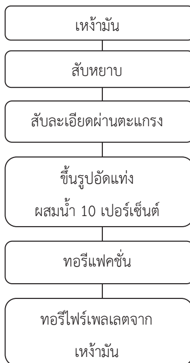
รูปที่ 4.2 แสดงแผนภูมิกระบวนการผลิตทอรีไฟร์เพลตจากเหง้ามัน ด้วยกระบวนการอัดแท่ง - ทอรีไฟร์
