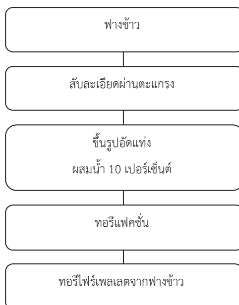
รูปที่ 4.3 แสดงแผนภูมิกระบวนการผลิตทอรีไฟร์เพลตจากฟางข้าว ด้วยกระบวนการอัดแท่ง – ทอรีไฟร์
