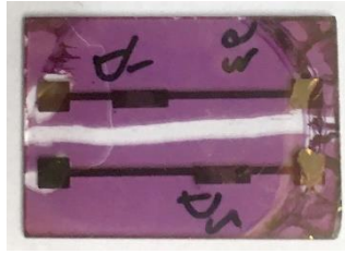
รูปที่ 2.37 แสดงภาพชิ้นงาน Water-gate OFETs ที่มี 2 ตัวอย่างบน 1 ชิ้นงาน
