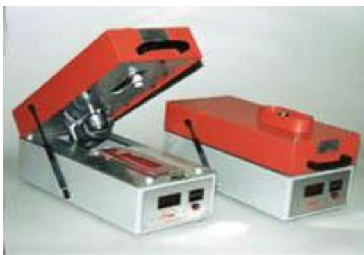
ภาพที่ 3.7 เครื่องทดสอบความคงทนของสีต่อการขัดถู (Crock meter)
