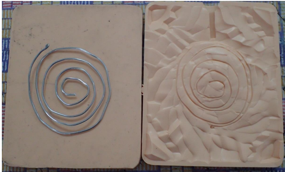
รูป 2.1.9 ตัวอย่างชิ้นงานทดสอบเส้นผ่านศูนย์กลาง 1 มม. ยาว 50 ซม. สำหรับทดสอบการไหลตัวของน้ำโลหะ
