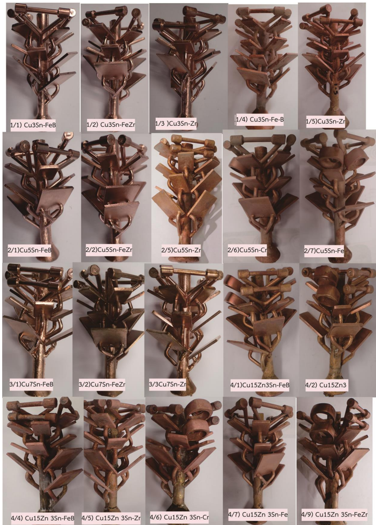
รูป 2.2.2 ต้นทองแดงผสมทดลองร่วมกับธาตุลดขนาดเกรนที่ผ่านการหล่อด้วยเตากระแสเหนี่ยวนำ ในระบบสุญญากาศ ร่อนเข็ม/ยิงทราย
