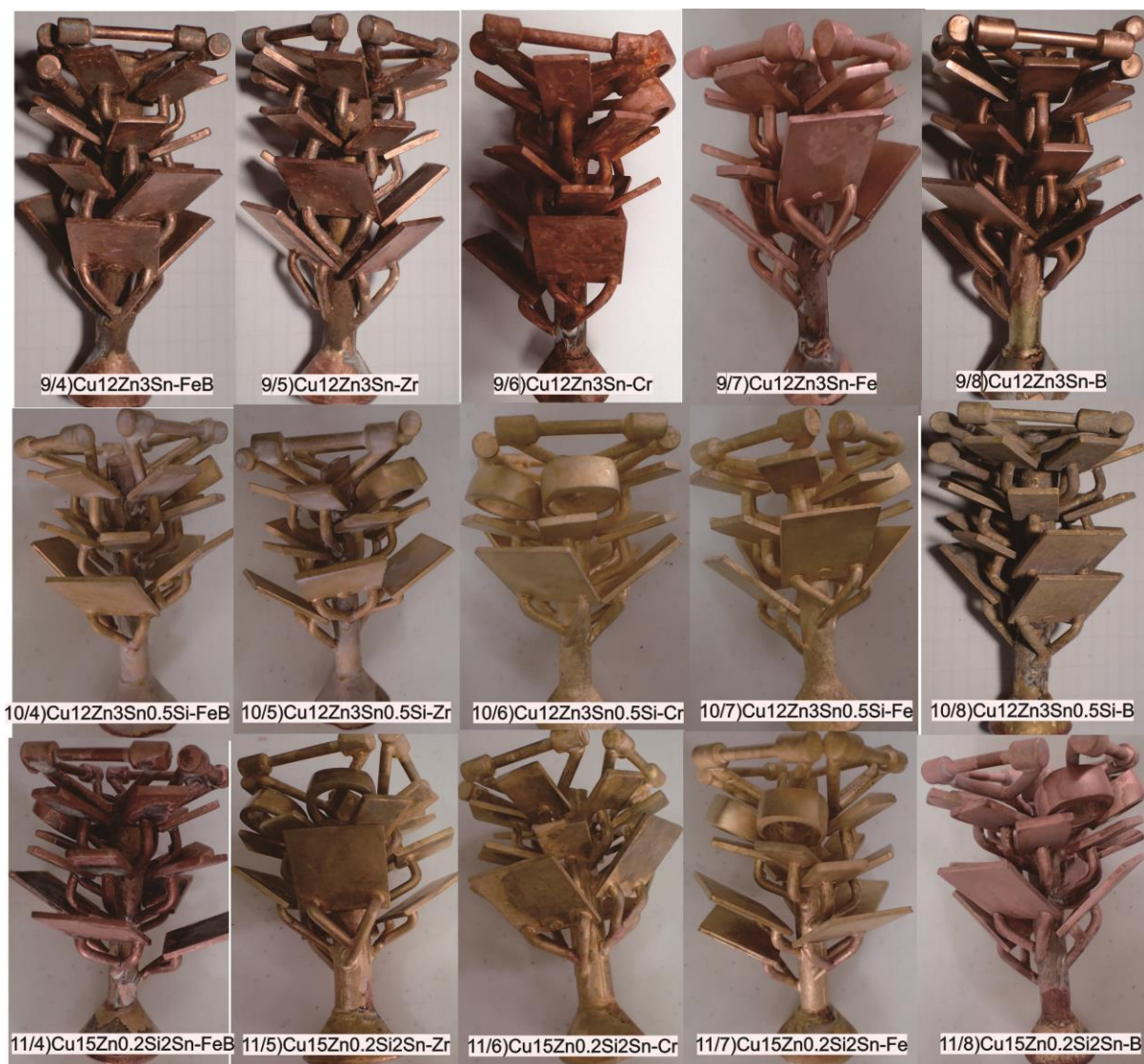
รูป 2.2.2 (ต่อ) ต้นทองแดงผสมทดลองร่วมกับธาตุลดขนาดเกรนที่ผ่านการหล่อด้วยเตากระแสเหนี่ยวนำ ในระบบสุญญากาศ ร่อนเข็ม/ยิงทราย
