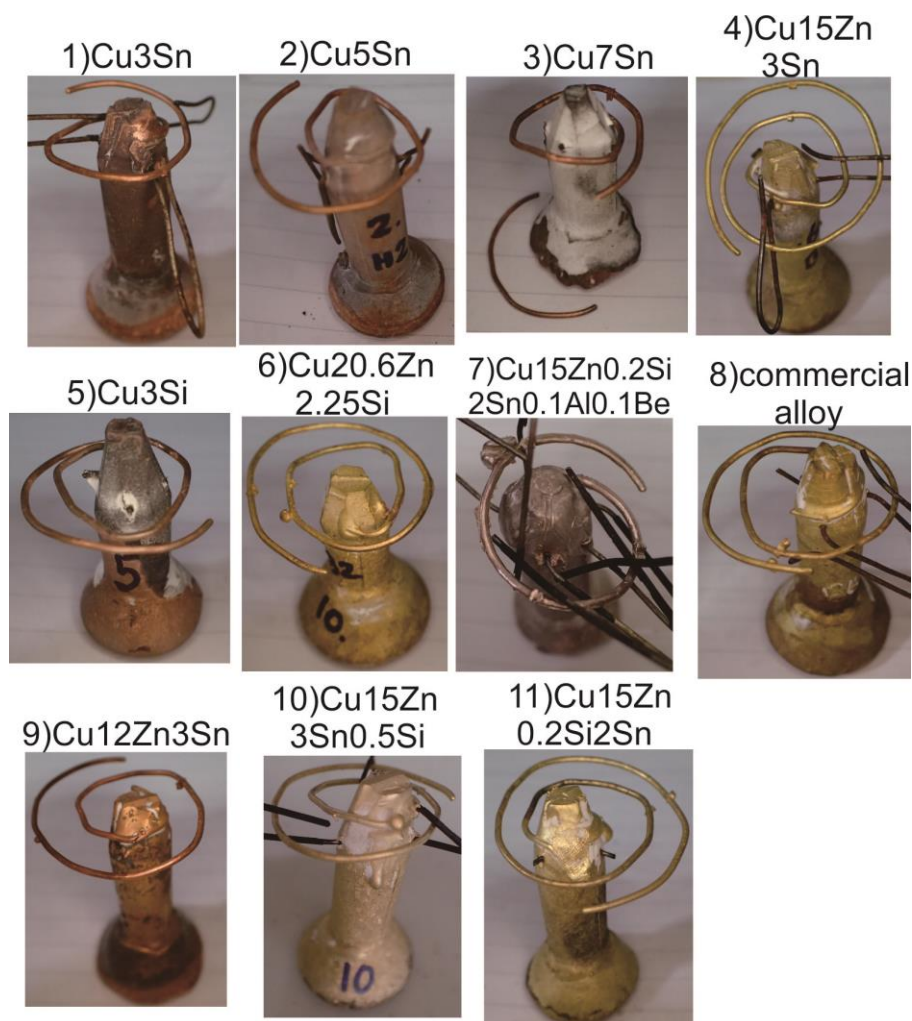
รูป 2.1.10 ตัวอย่างชิ้นงานทดสอบเส้นผ่านศูนย์กลาง 1 มม. ยาว 50 ซม. สำหรับทดสอบการไหลตัวของน้ำโลหะ ผ่านการหล่อที่อุณหภูมิ 1100 องศาเซลเซียส และอุณหภูมิ 550 องศาเซลเซียส
