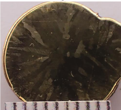
รูป 2.3.2 (ต่อ) การเปรียบเทียบขนาดเกรนของชิ้นงานทองแดงผสมร่วมกับธาตุลดขนาดเกรน
