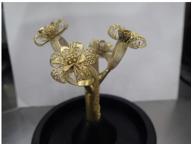
รูป 2.7.1 แสดงตัวอย่างชิ้นงานทองเหลืองCu28Zn3Si ที่เหมาะสมสำหรับการหล่อเรซิน 3D-printing เนื่องจากไหลตัวง่าย แข็งแรงสูง คงรูปได้ดี
