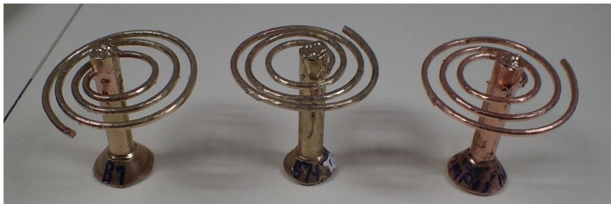
รูป 2.1.6 ตัวอย่างชิ้นงานทดสอบการไหลตัวน้ำโลหะและขนาดชิ้นงาน (มม.)
