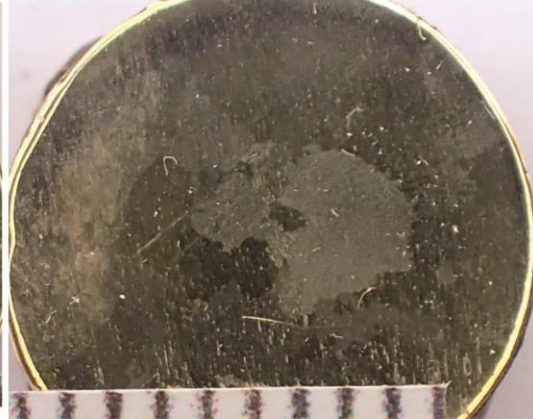
รูป 2.3.2 (ต่อ) การเปรียบเทียบขนาดเกรนของชิ้นงานทองแดงผสมร่วมกับธาตุลดขนาดเกรน
