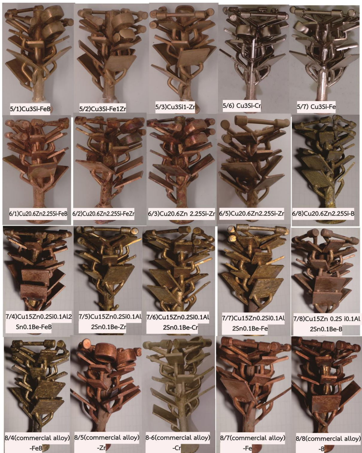
รูป 2.2.2 (ต่อ) ต้นทองแดงผสมทดลองร่วมกับธาตุลดขนาดเกรนที่ผ่านการหล่อด้วยเตากระแสเหนี่ยวนำ ในระบบสุญญากาศ ร่อนเข็ม/ยิงทราย
