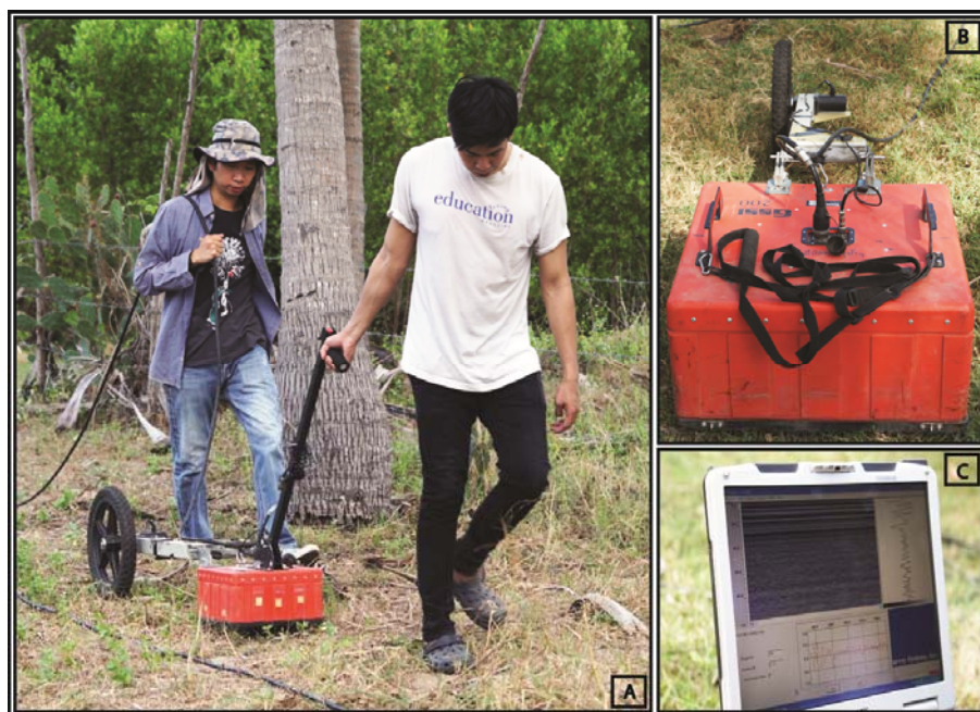
รูป 3 แสดงการลากสำรวจตาม Transect โดยใช้ตัวส่งสัญญาณคลื่น 400 MHz B. ตัวส่งสัญญาณคลื่น 200 MHz C. จอแสดงผลการรับสัญญาณ
