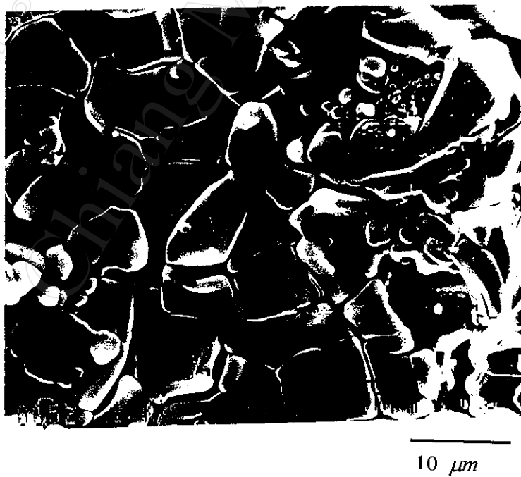
รูปที่ 4.38 แสดงภาพถ่าย SEM ด้านข้างของฟิล์ม PZT 20 ชั้น ความหนา 26.75 \mu\text{m}
