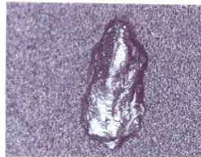
รูป 4.37 เศษเหล็กขึ้นแรกของการชำรุด ที่มีรูปร่างนอกของแบร็ง
