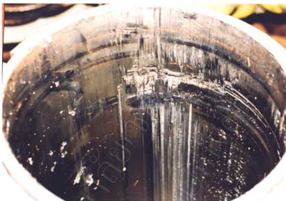
รูป 1.5 ลักษณะการชำรุดแบบรอยครูดภายในกระบอกไฮดรอลิค โดยมีสาเหตุจากการชำรุดแบบรุนแรงของแบริ่งในปั๊มไฮดรอลิค
