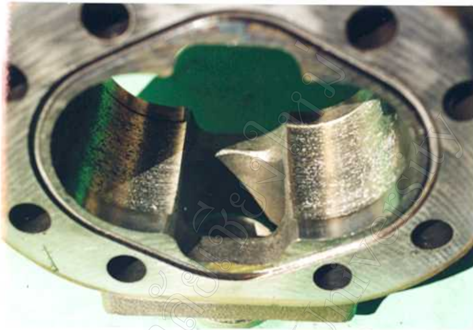
รูป 1.3 การสึกหรอของเสื้อสูบไฮดรอลิค จากสาเหตุการชำรุดของแบริ่ง ทำให้เพื่องเกียรไปกัดเสื้อสูบ
