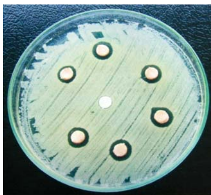
รูปที่ 7 การทดสอบการยับยั้งแบคทีเรียของชิ้นงาน PVP+Amp/PCL ด้วยเทคนิค agar disc diffusion
