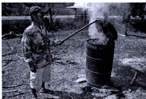
ด้านบนสามารถเปิดฝาบรรจุเศษไม้ได้ ด้านล่างเจาะช่องให้มีการเผาไหม้จากหลุมดิน
