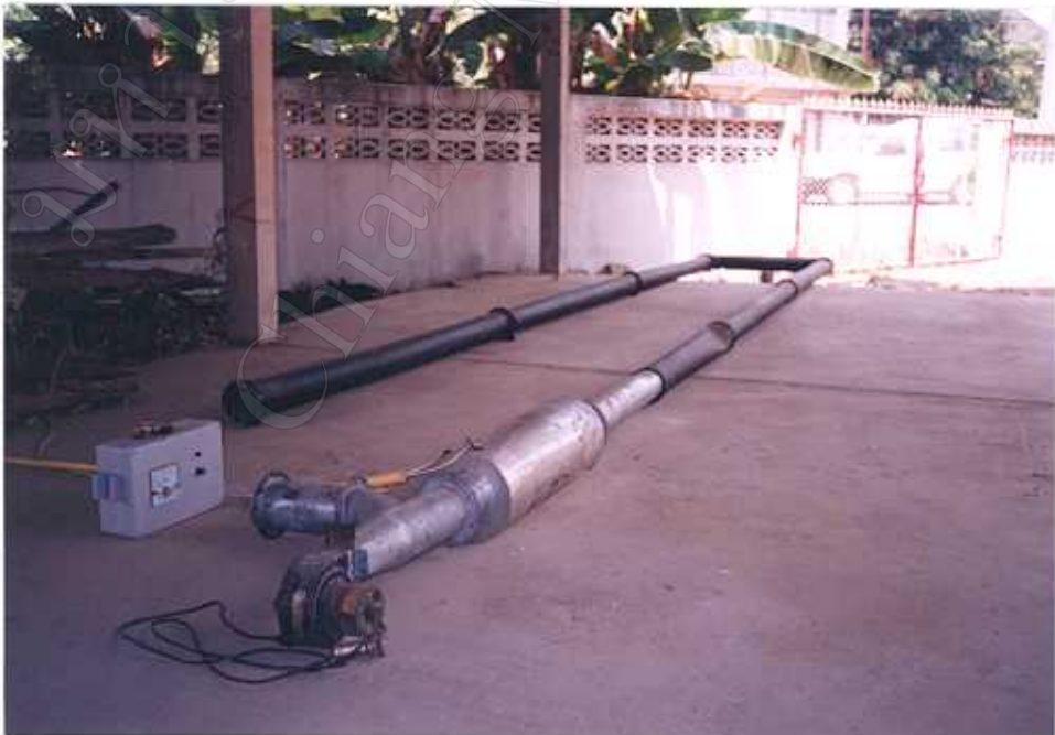
รูป 3.4 แสดงภาพถ่ายชุดทดสอบการไหลของอากาศ ท่อกลมขนาด 101.6 mm (4 นิ้ว)
