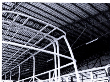
ภาพที่ 3.12 แสดงโครงสร้างด้านหลังรถยนต์โดยสาร
