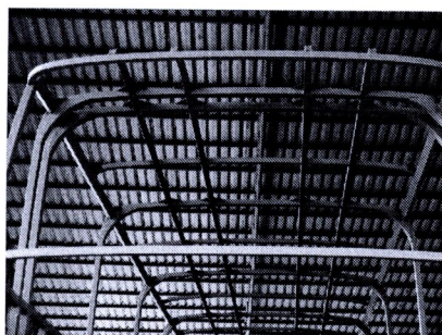
ภาพที่ 3.12 แสดงโครงสร้างด้านหลังรถยนต์โดยสาร
