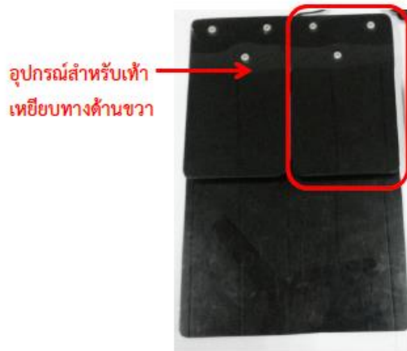
ภาพที่ 6 ภาพแสดงการทำงานของอุปกรณ์สำหรับเท้าเหยียบทางด้านขวาของเครื่องวัดอัตราการตอบสนองแบบ 3 มิติ
