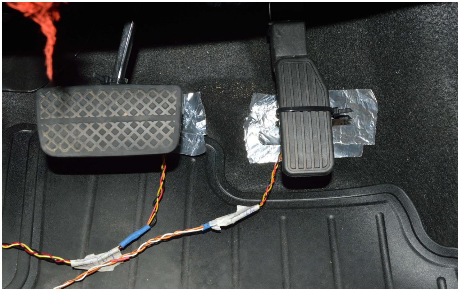
ภาพที่ 19 ภาพจำลองการติดตั้งการติดตั้งอุปกรณ์ คันเร่ง เบรก
