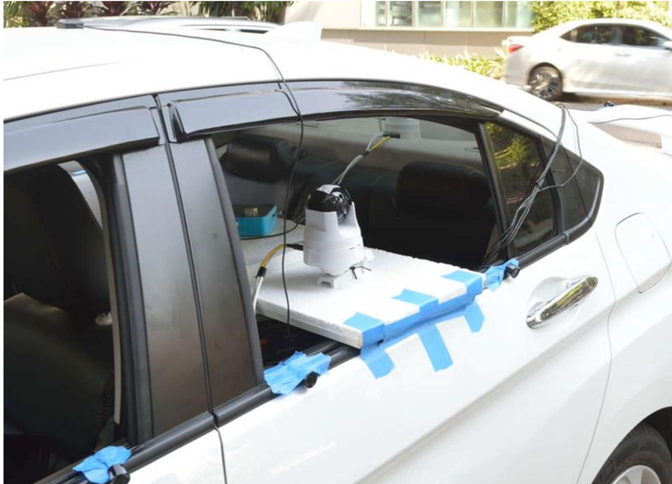
ภาพที่ 14 ภาพจำลองการติดตั้งอุปกรณ์ด้านข้างรถยนต์
