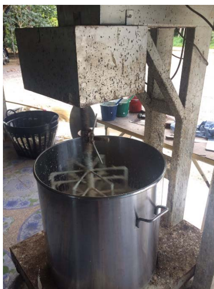
ภาพที่ 3.1 อุปกรณ์ชุดปั่นกวนน้ำยางกับสารเคมีต่างๆ ในการผลิตโฟมยาง ที่ใช้ในวิสาหกิจชุมชน
