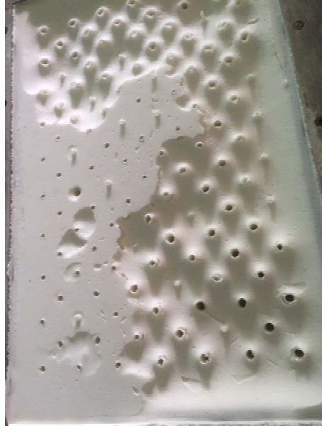
ภาพที่ 4.7 ลักษณะการยุบตัวของโฟมยางเนื่องจากโฟมยางเซตตัวก่อนปิดฝา
