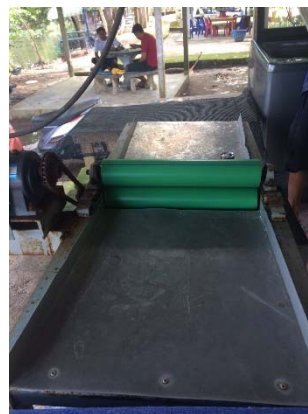
ภาพที่ 3.4 (ก) ขั้นตอนการล้างโฟมยาง (ข) ขั้นตอนการรีดน้ำออกจากโฟมยาง
