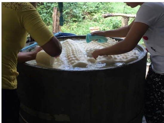
ภาพที่ 3.4 (ก) ขั้นตอนการล้างโฟมยาง (ข) ขั้นตอนการรีดน้ำออกจากโฟมยาง
