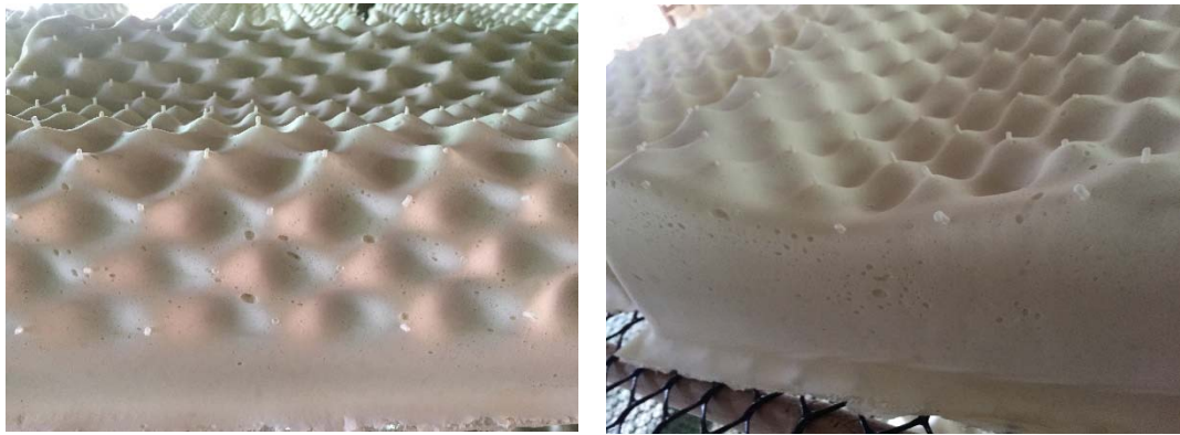
ภาพที่ 4.12 ลักษณะฟองอากาศตามผิวของโฟมยาง
