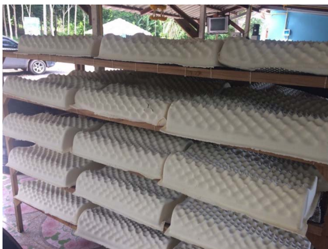
ภาพที่ 3.5 ขั้นตอนการตากผึ่งลมโฟมยางจนแห้งสนิท
