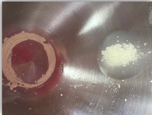
ภาพที่ 4.5 ลักษณะการตกตะกอนที่ก้นภาชนะปั่นกวนโฟมยางของสารเคมีที่มีความหนืดสูง
