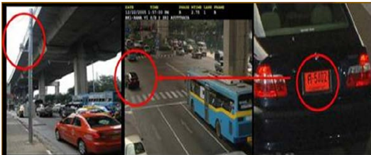
ภาพที่ 5.3 ระบบตรวจจับรถฝ่าฝืนสัญญาณไฟจราจร หรือ Red Light Camera
