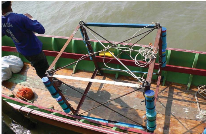
รูปที่ 7.3 รูปของเครื่องดักตะกอนที่ทำจากเหล็กฉากและท่อพีวีซี (แบบ 2 ระดับ)
