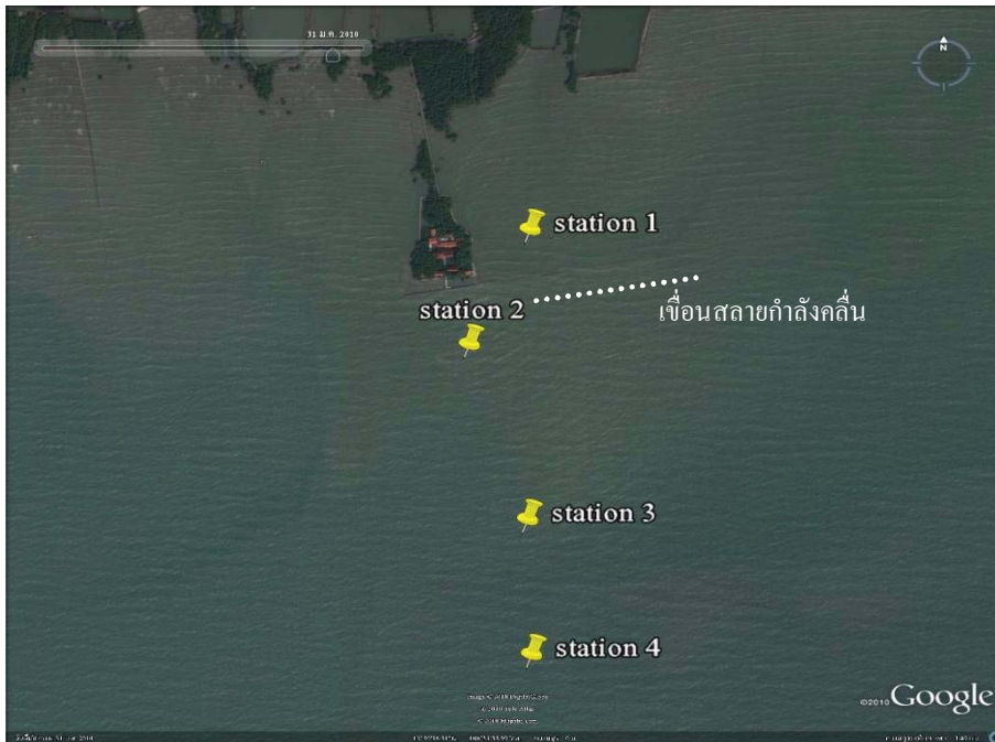
รูปที่ 7.6 จุดติดตั้งเครื่องตักตะกอน จุดที่ 1 - 4 ห่างจากชายฝั่งประมาณ 0.3, 0.5, 0.85 และ 1.1 กิโลเมตรตามลำดับ
