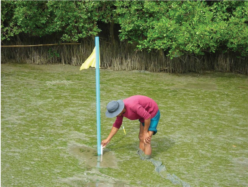
รูปที่ 4.2 หมุดตรวจวัดข้อมูลระดับตะกอนซึ่งทำจากวัสดุ PVC ขนาดเส้นผ่าศูนย์กลาง 1\frac{1}{2} นิ้ว ยาว 6-7 เมตร
