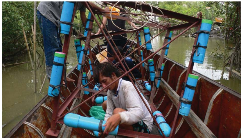
รูปที่ 7.4 รูปของเครื่องดักตะกอนที่ทำจากเหล็กฉากและท่อพีวีซี (แบบ 3 ระดับ)
