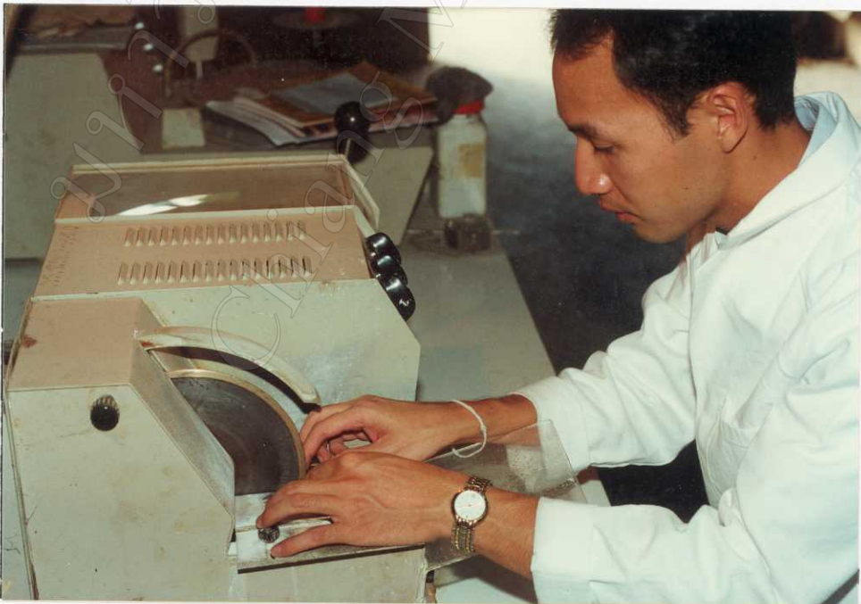
รูป 22 แสดงการตัดชิ้นงานแก้วด้วยเครื่องตัด
