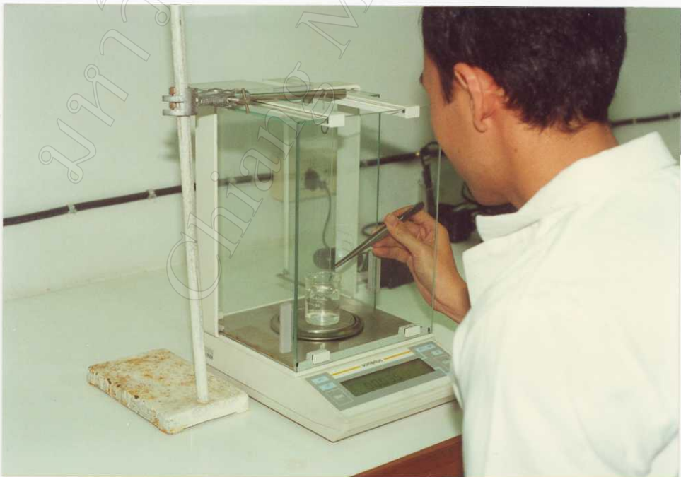
รูปที่ 28 แสดงการหย่อนชิ้นทดสอบแก้วลงในหลอดวงน้ำหนักที่จมอยู่ในน้ำ
