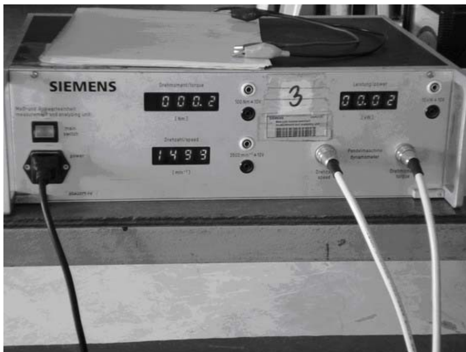
รูปที่ 5.75 Siemens Measurement and Analyzing Unit (วัดทอร์ก, วัดความเร็วรอบ, วัดกำลังที่จ่าย โหลด จากการ ทำงานของมอเตอร์)
