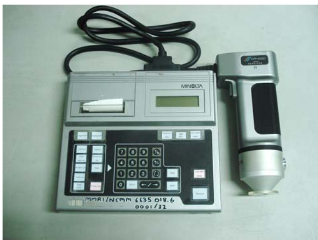
รูปที่ 3.10 เครื่อง Chromameter รุ่น CR-200 ผลิตโดยบริษัท Minolta
