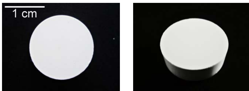
รูปที่ 4.1 ลักษณะทั่วไปของชิ้นงานซิลิคอนไนไตรด์
