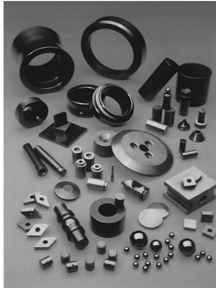
รูปที่ 2.8 ตัวอย่างส่วนประกอบของเครื่องยนต์ที่ทำจากซิลิคอนไนไตรด์
