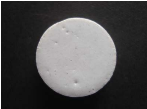
รูปที่ 4.2 ลักษณะพื้นผิวของเคลือบแก้วบอโรซิลิเกต (a-i) และแก้วบอโรซิลิเกตผสมเซอร์โคเนีย ปริมาณร้อยละ 5 (j-r) บนผิวซิลิคอนไนไตรด์ ณ อุณหภูมิต่างๆ
