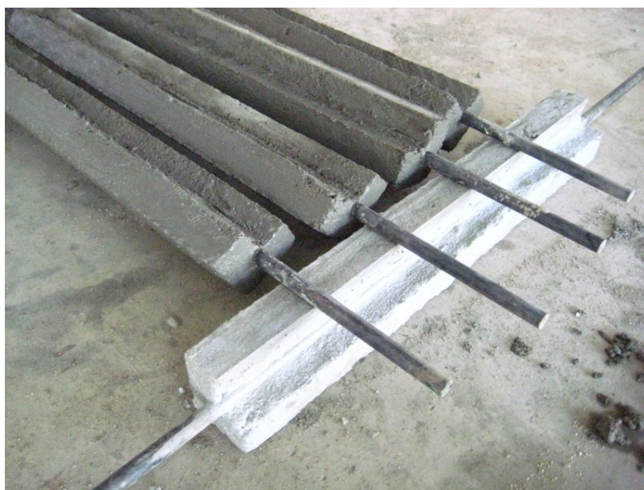
รูปที่ 4.2 ตัวอย่างแท่งทดลองคอนกรีต
