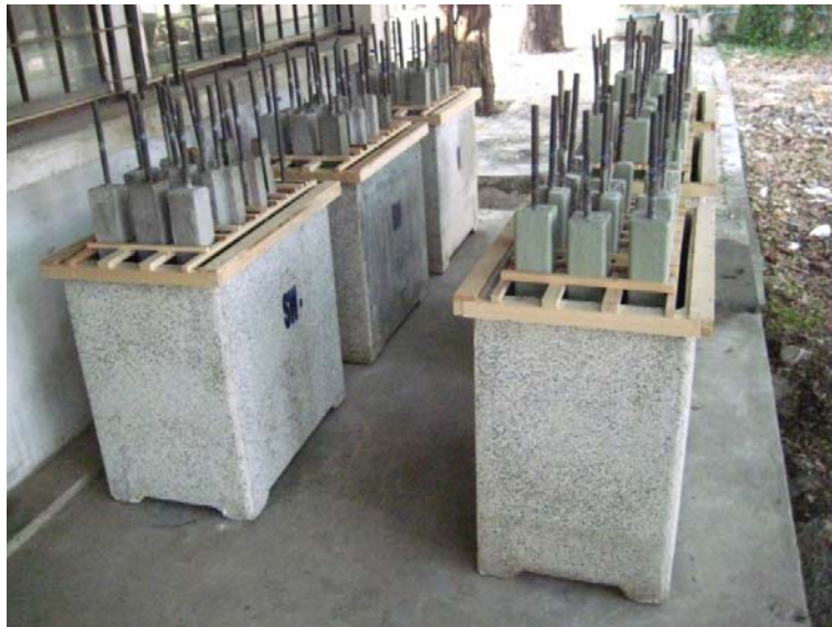
รูปที่ 4.4 แท่งทดลองที่จุ่มแช่ในน้ำทะเล น้ำร่อยและน้ำจืด
