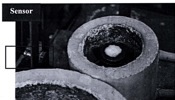
รูปที่ 3.14 ขดลวดสำหรับอุ่นคูลล์ โดยควบคุมอุณหภูมิด้วย Sensor
