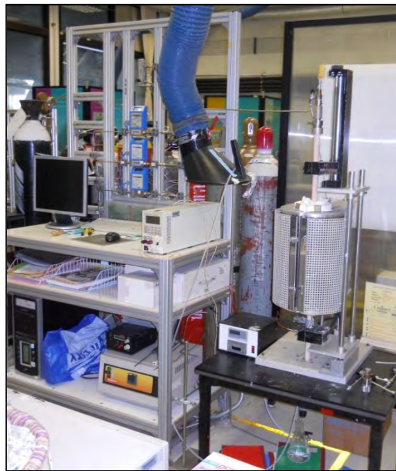
รูปที่ 29 เครื่องทดสอบประสิทธิภาพของเซลล์เชื้อเพลิงชนิดเซลล์เดี่ยว (fuel cell test station)
