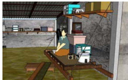
รูปที่ 2.43 ตัวอย่างการเตรียมโครงสร้างคานพื้นแบบแขวนกับคานหลังคา (ที่มา: ณิชวิชัย, 2557)
