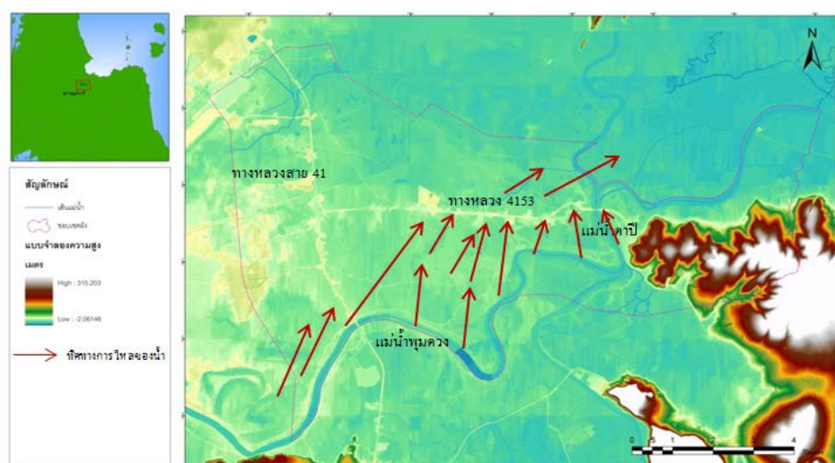
รูปที่ 2.16 ผลกระทบระดับความสูงทางหลวงสาย 4153 ต่อทิศทางการไหลและการระบายน้ำ (ที่มา:วนารัตน์ และคณะ, 2556)
