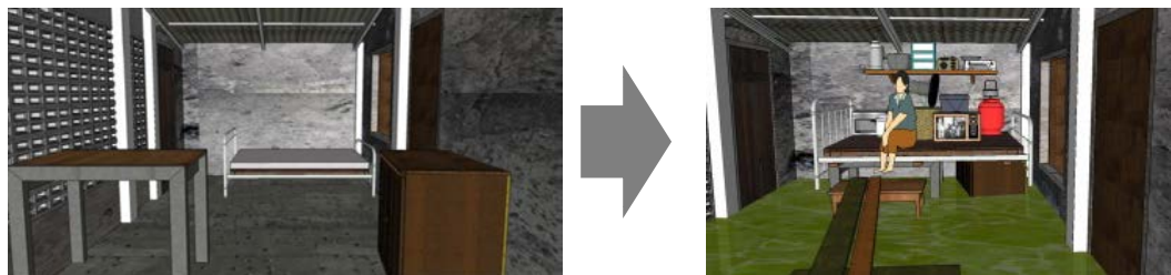
รูปที่ 2.38 การจัดเรียงเฟอร์นิเจอร์เป็นพื้นที่กั้นอยู่หลับนอนช่วงน้ำท่วม (ที่มา: ณิชวิชัย, 2557)
