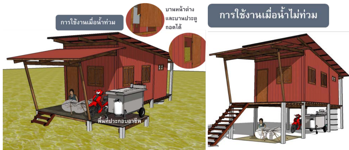
รูปที่ 1.33 ตัวอย่างรูปแบบที่อยู่อาศัยที่เหมาะสมคือ “บ้านชั้นเดียว ใต้ถุนสูง” เพื่อปล่อยให้น้ำผ่านและสามารถใช้พื้นที่ใต้ถุนได้ในช่วงเวลาที่น้ำไม่ท่วม (ที่มา: ณัชวิชัย และสิบบงศ์, 2558)
