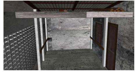
รูปที่ 2.42 ตัวอย่างการเตรียมโครงสร้างคานพื้นแบบวางบนจตุรองรับบนเสาไม้ (ที่มา: ณิชวิชัย, 2557)
