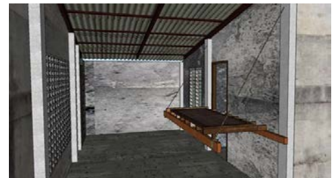
รูปที่ 2.43 ตัวอย่างการเตรียมโครงสร้างคานพื้นแบบแขวนกับคานหลังคา (ที่มา: ณิชวิชัย, 2557)
