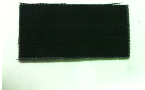
รูปที่ 1 ตัวเร่งปฏิกิริยาแพลทินัมที่เตรียมเต็มพื้นที่ผิวบนผ้าคาร์บอน
