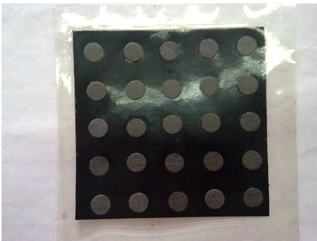
รูปที่ 3 เยื่อแผ่นประกอบขั้วไฟฟ้าแบบแถวลำดับ
