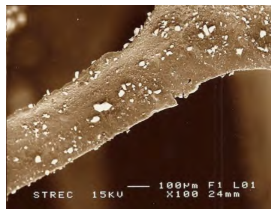
รูปที่ 4.7 โครงสร้างมหภาคของโฟมอะลูมิเนียมผสมกับเศษอะลูมิเนียมเกรด ADC12 ในปริมาณ 10 wt.% ที่มีโพรงอากาศขนาด 12 ppi
