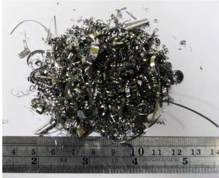
รูปที่ 4.1 ลักษณะเศษโลหะอะลูมิเนียมเกรด ADC12
