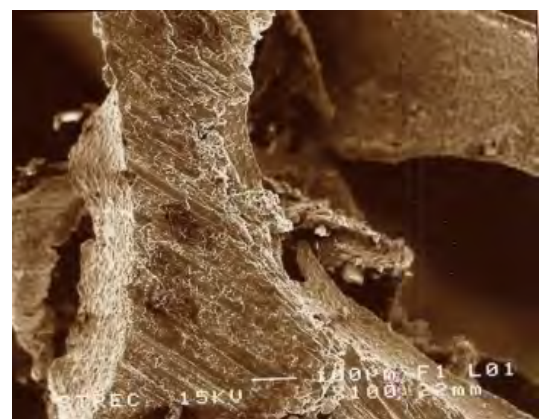
รูปที่ 4.2 โครงสร้างมหภาคของโฟมอะลูมิเนียมบริสุทธิ์ที่มีโพรงอากาศขนาด 8 ppi
