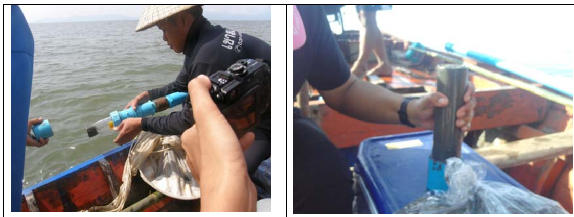
รูปที่ 34 การเก็บตัวอย่างตะกอนดินในแนวติ่งด้วย sediment corer
