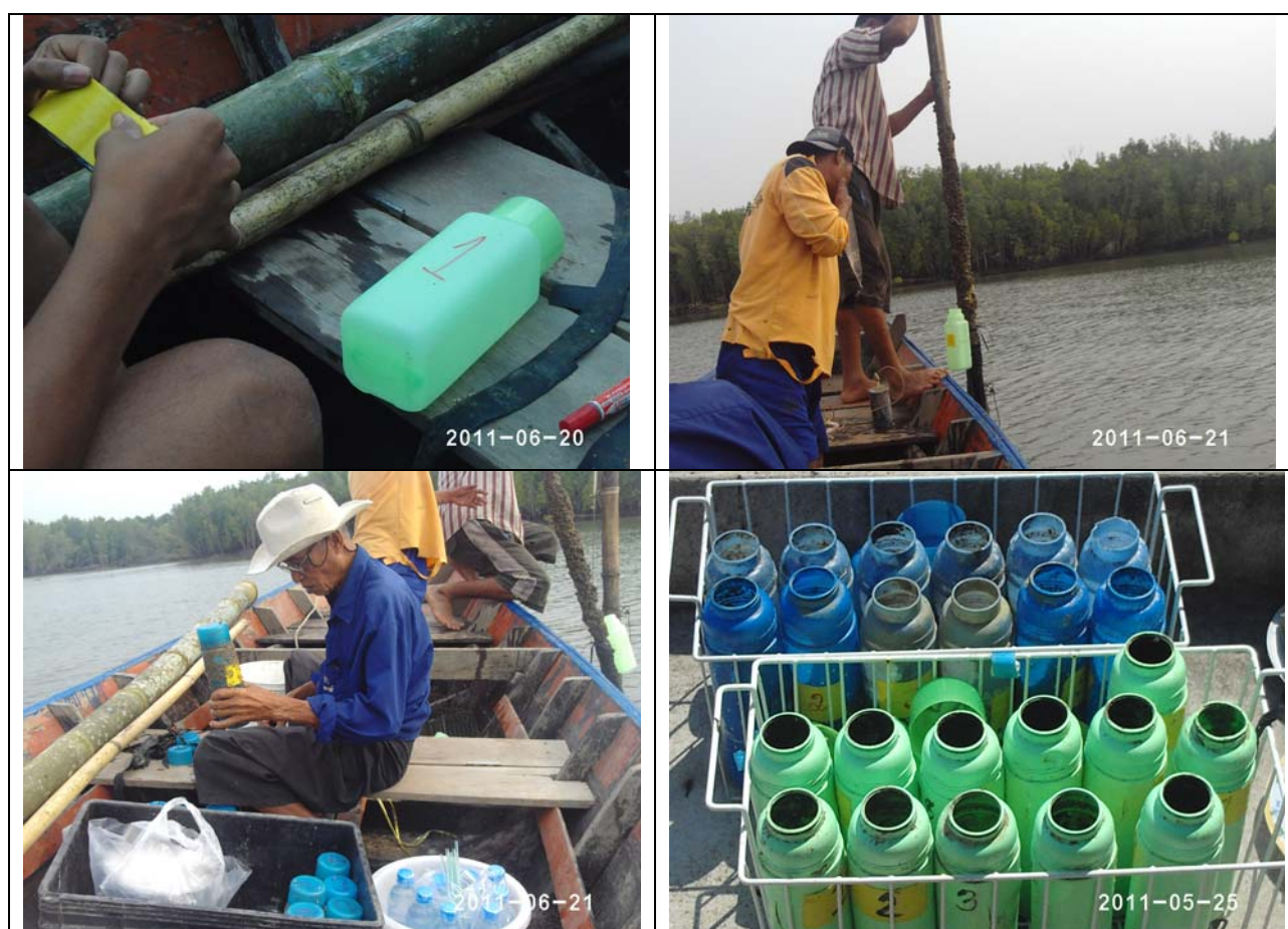
รูปที่ 30 การศึกษาอัตราการตกตะกอนด้วยเครื่องดักตะกอน
