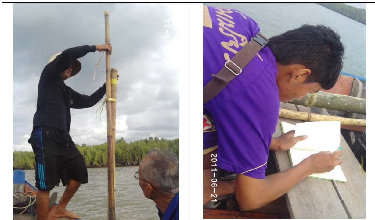
รูปที่ 28 บักเสาไม้ไผ่วัดระดับพื้นทะเล
