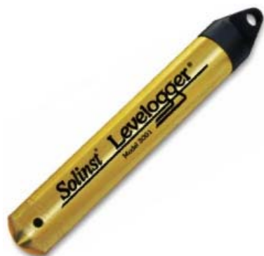
รูปที่ 20 เครื่องวัดระดับน้ำที่สามารถนำมาใช้วัดคลื่น ยี่ห้อ Solinst รุ่น 3001
