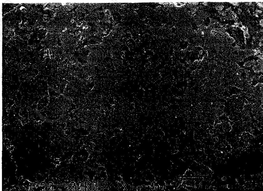
รูปที่ 4.47 ภาพถ่ายแสดงลักษณะอนุภาคพีแซดทีในเมตริกซ์พอลิเอธิลีน ความหนาแน่นสูง ที่อัตราส่วน 60 : 40 โดยเทคนิคการเจือผงแกรไฟต์แบบ (1.5C)58.5PZT/40HDPE กำลังขยาย 1500 เท่า
