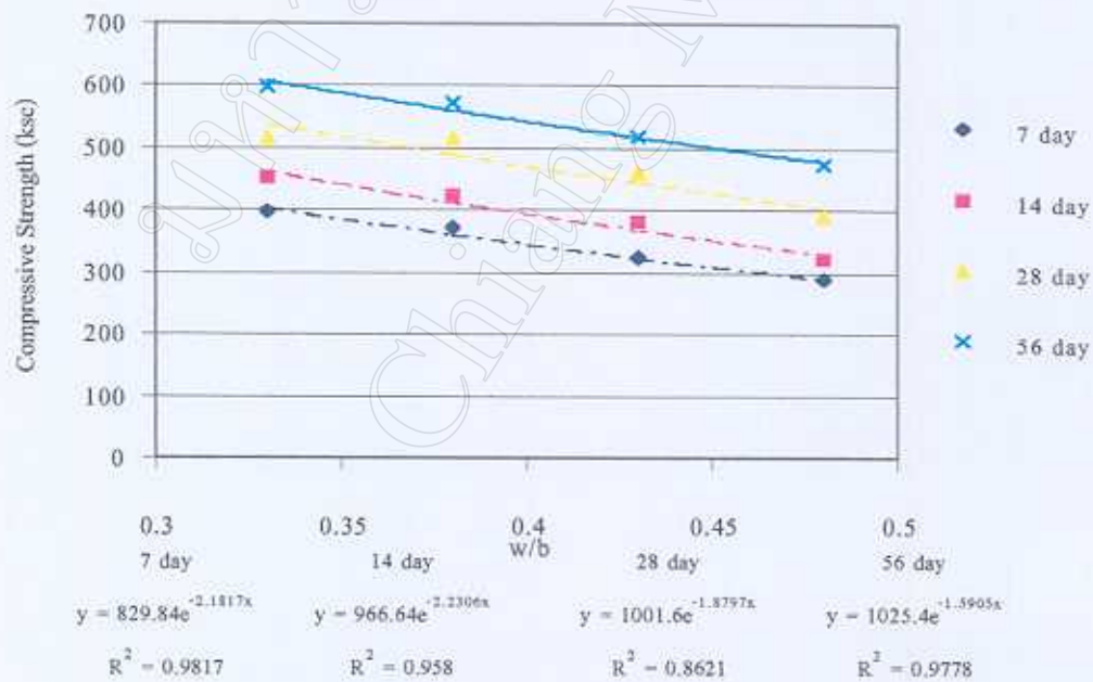
รูปที่ 5.12 ความสัมพันธ์ระหว่างกำลังอัดประลัยกับอัตราส่วน w/b สำหรับคอนกรีตผสมเถ้าลอยร้อยละ 35
