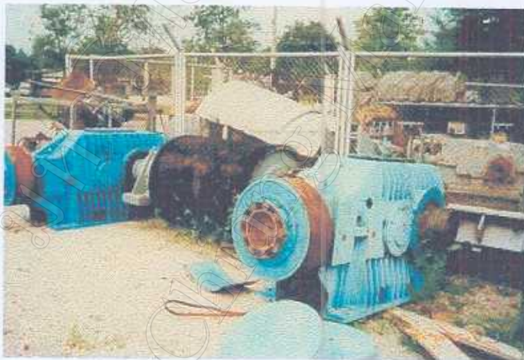
รูปที่ 1.8 ชุดขับเคลื่อนสายพานที่เกิดไฟไหม้
