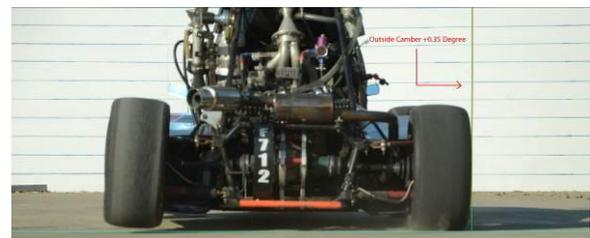
(d)  $-3.0^\circ$ , rear camber =  $+0.35^\circ$ , roll angle =  $1.10^\circ$
