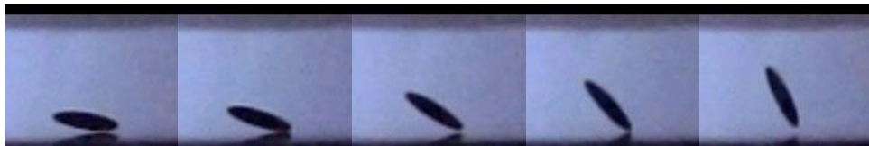
รูปที่ 10 ภาพตามลำดับเวลาจากซ้ายไปขวา ของอนุภาคขนาดเล็กที่มีการสัมผัสการอเล็กโตรดด้านล่างซ้ำ หลังจากที่ได้แยกตัวออกจากอเล็กโตรดแล้ว
