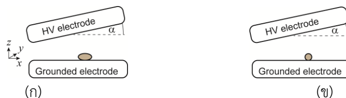
รูปที่ 16 อนุภาคมีแนวแกนขนานกับ (ก) เกรเดียนต์ของสนามไฟฟ้า ในรูปแบบจัดเรียงแบบ A และ (ข) เส้นสนามไฟฟ้าเท่า สำหรับการจัดเรียงแบบ B.
